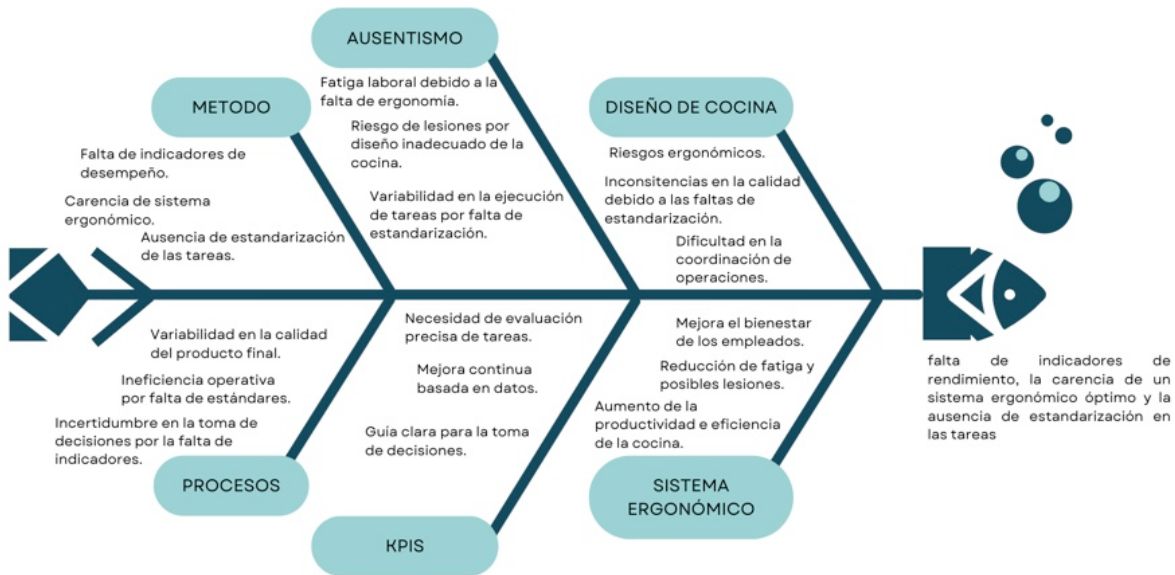
Figura IV. Diagrama Ishikawa. (Método de Kaoru Ishikawa, adaptado por Andrés Duque, Juan Diego Rico, Camilo Yusti, Santiago Zúñiga).
