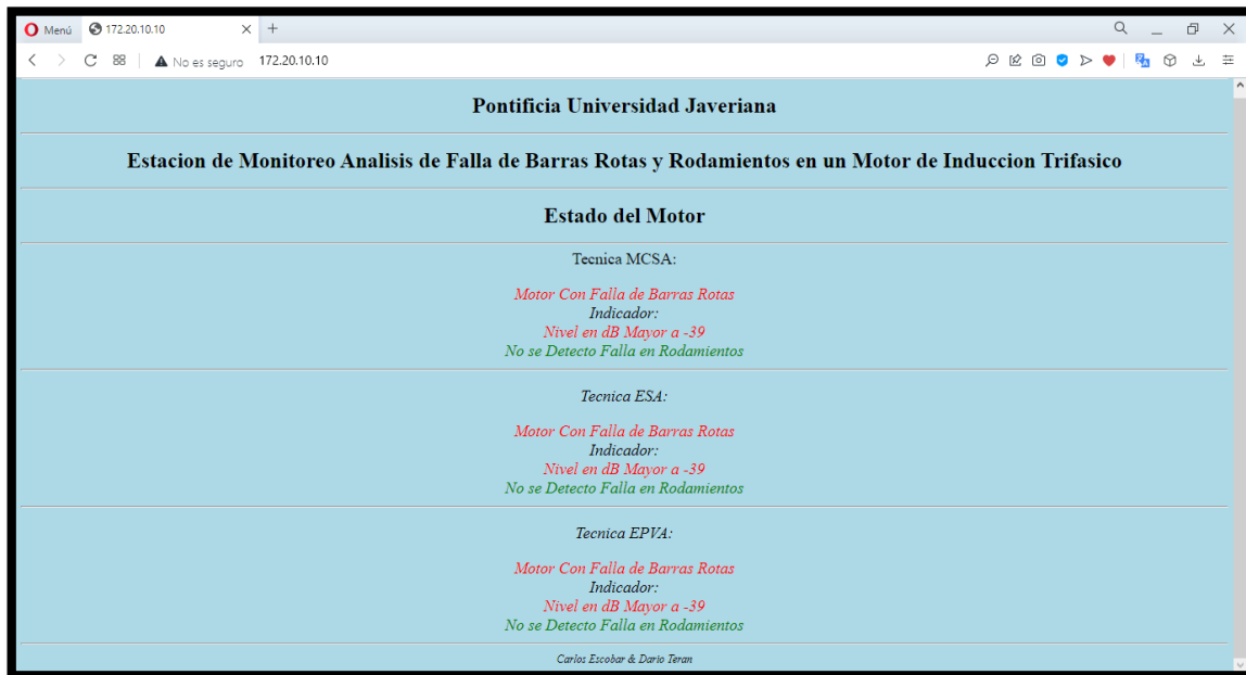
Figura 30. Resultado Interfaz web motor con barras rotas en rotor
