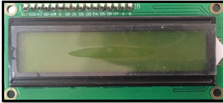
Figura 16. Pantalla LCD 16x2
