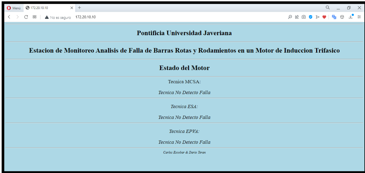
Figura 20. Interfaz Generada a través de la conexión Ethernet
