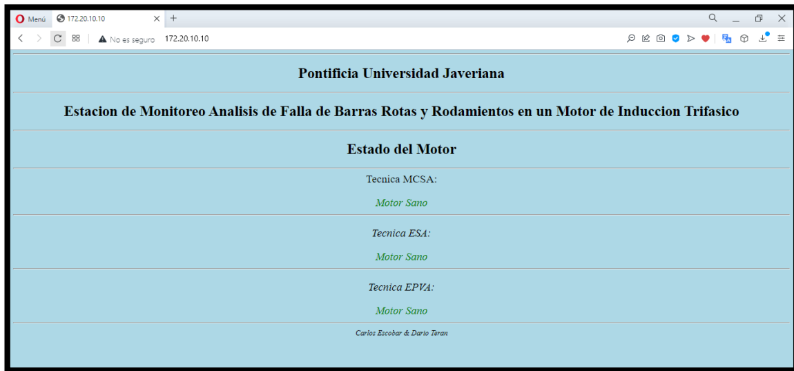
Figura 31. Resultado Interfaz web motor sano
