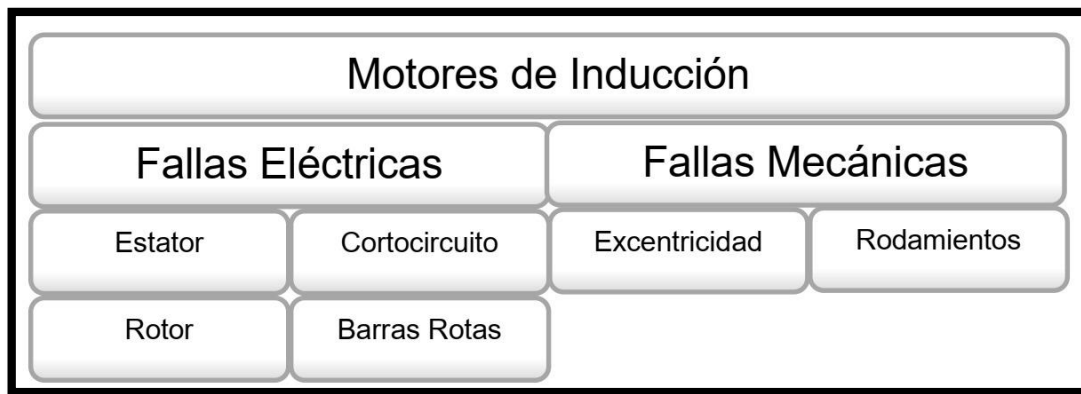
Figura 2. Fallas eléctricas y mecánicas.
