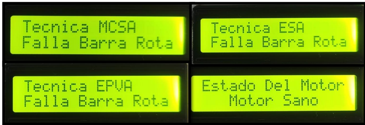
Figura 29. Visualización Display LCD barras rotas
