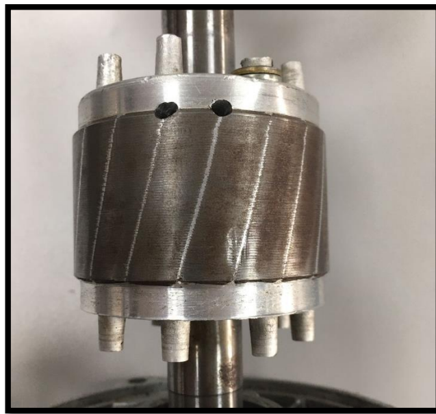
Figura 27. Falla de barras rotas en rotor
