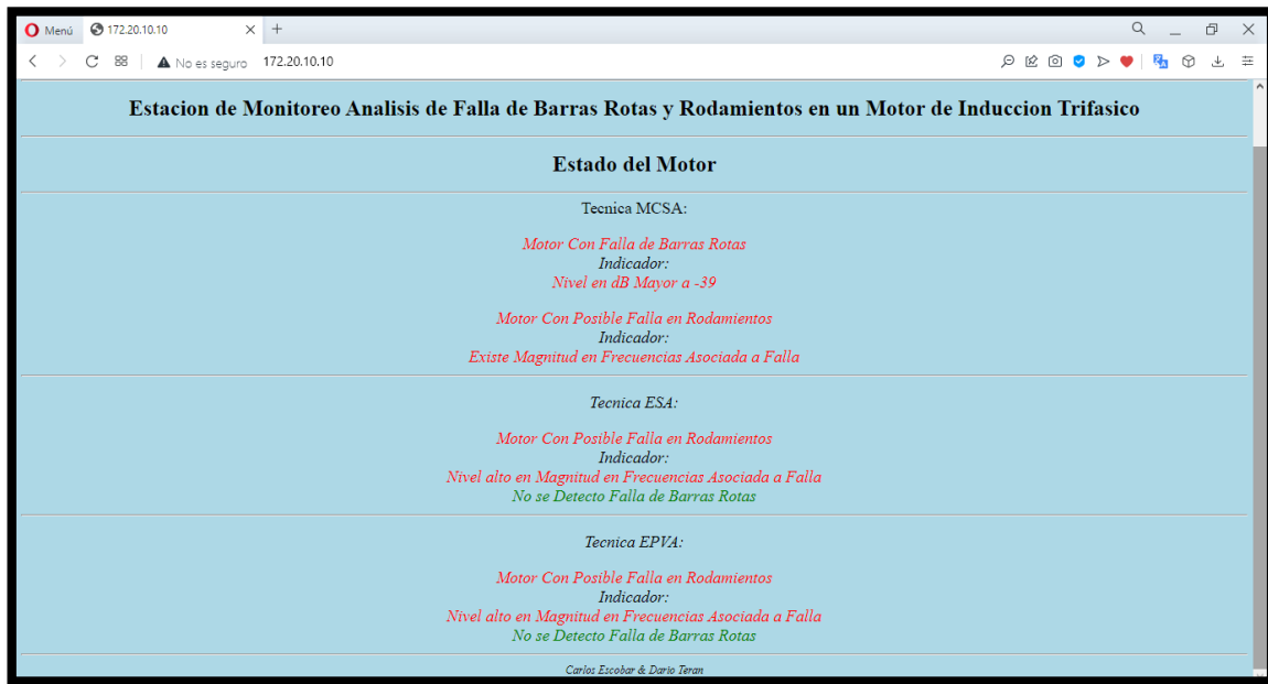
Figura 33. Resultado Interfaz web motor con fallo en rodamientos
