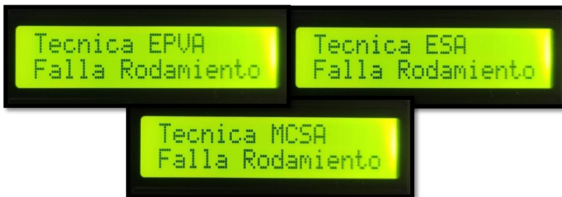
Figura 32. Resultado Análisis LCD motor con fallo en rodamientos
