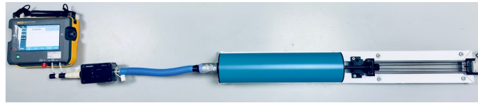
Figura 7.3: Montaje 1 VT650 presión diferencial-Citrex para flujo
