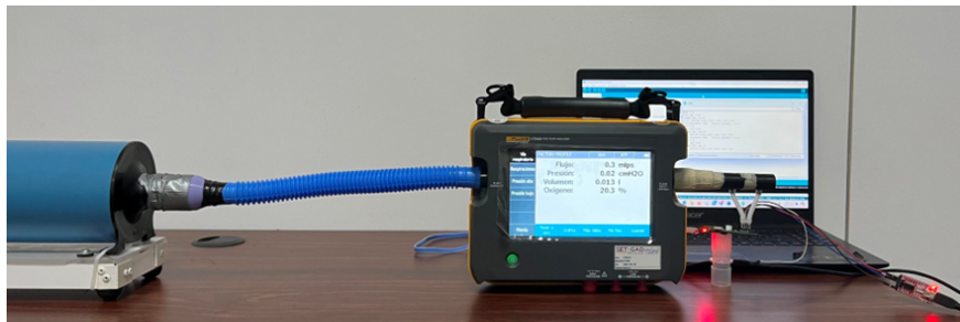
Figura 7.7: Montaje para verificación de volumen
