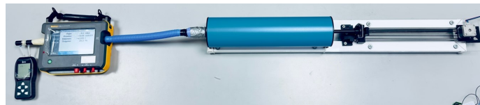
Figura 7.4: Montaje 2 VT650 para flujo-Manómetro para presión diferencial
