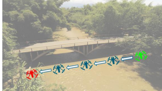
Figura 35 Misiones libres, 1 m, 3,5m y 9,0m de altura sobre nivel del río Claro, 40 m de longitud por trayecto, + 30°, 0° y - 45° inclinaciones verticales de la cámara. Hacia K0+028
