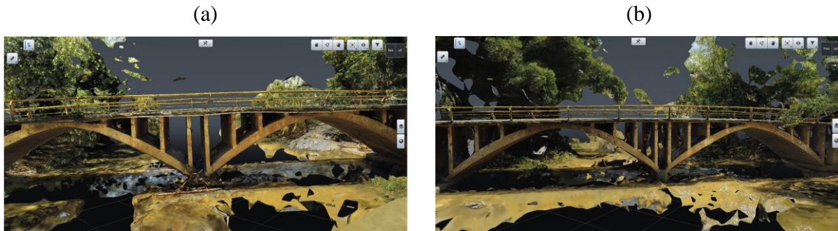
Figura 52 Modelo digital 3D Puesto Río Claro, Software ContextCapture. (a) Vista Lateral Aguas Arriba (b) Vista Lateral Aguas Abajo (c) Vista en Planta (d) Vista Inferior
