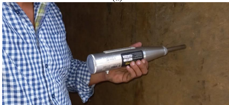
Figura 58 Ensayo en campo, esclerometría. (a) Posición esclerómetro. (b) Número de rebote
