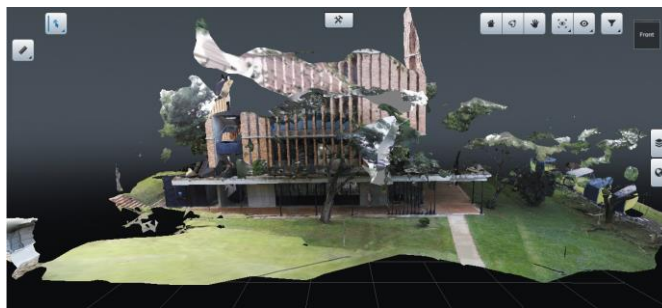
Figura 15 Modelado 3D incompleto, edificio “El Cedro Rosado”
