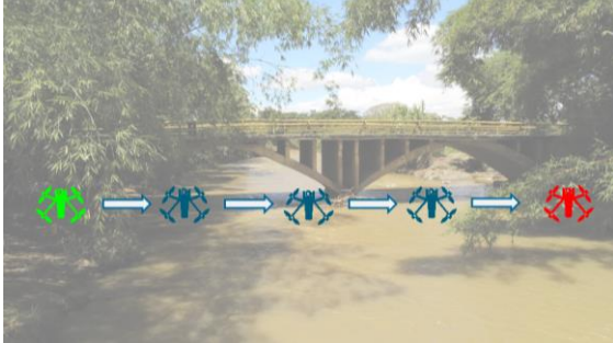
Figura 34 Misiones libres, 1 m, 3,5m y 9,0m de altura sobre nivel del río Claro, 40 m de longitud por trayecto, + 30°, 0° y - 45° inclinaciones verticales de la cámara. Hacia K0+000
