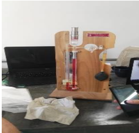
Figura 30. Finura de cemento mediante aparato de Blaine. Fuente: el autor.
