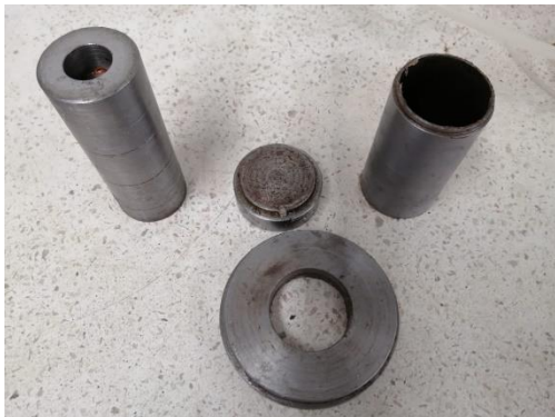
Figura 45. Molde para la compactación de los especímenes con mezclas de suelo y ARCe. Fuente: el autor.
