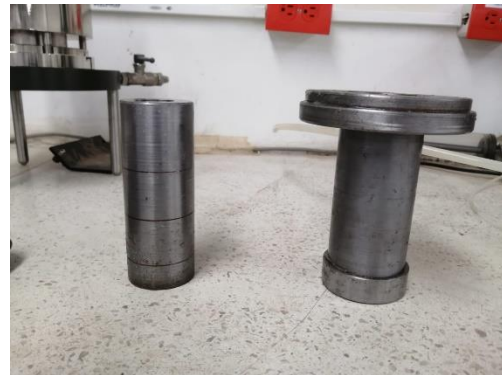
Figura 45. Molde para la compactación de los especímenes con mezclas de suelo y ARCe. Fuente: el autor.
