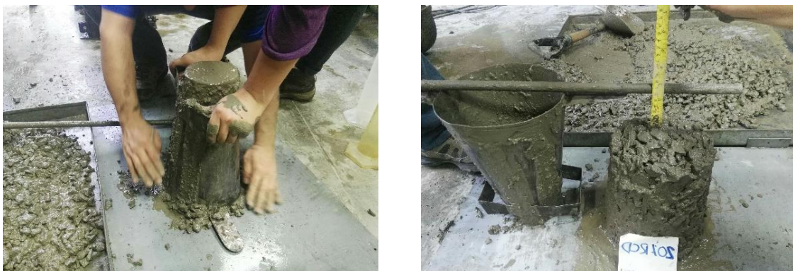
Figura 36. Toma de asentamiento utilizando el cono de Abrams. Fuente: el autor.
