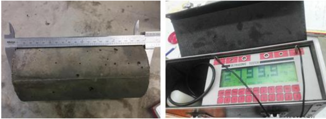
Figura 59. Toma de dimensiones del cilindro y ensayo de velocidad de pulso ultrasónico. Fuente: el autor.
