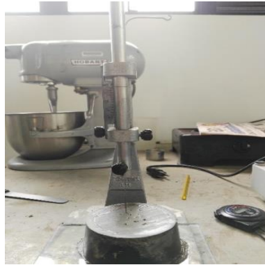
Figura 31. Tiempo de fraguado y control de temperatura. Fuente: el autor.
