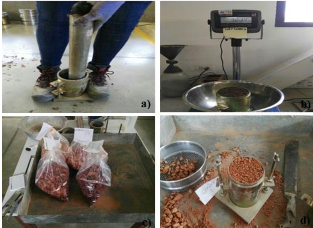
Figura 44. Realización de ensayo de Proctor estándar: a) compactación de las muestras; b) pesaje; c) ajuste de la humedad y reposo; y d) enrase al final del ensayo. Fuente: el autor.
