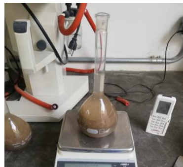
Figura 29. Gravedad específica y absorción en arena. Fuente: el autor.
