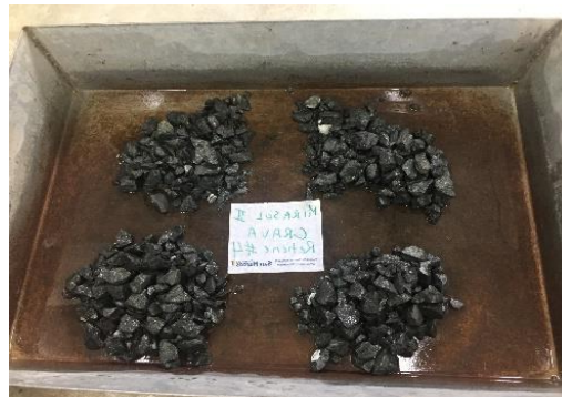
Figura 28. Ensayo de gravedad específica y absorción en la grava. Fuente: el autor.
