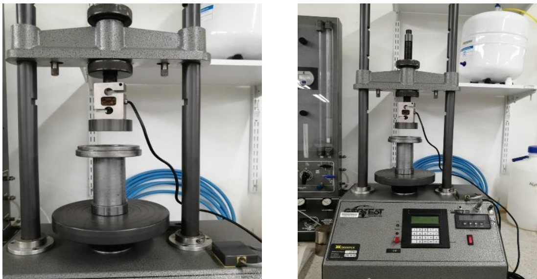
Figura 46. Montaje del molde en la prensa triaxial para la compactación semi-estática.
