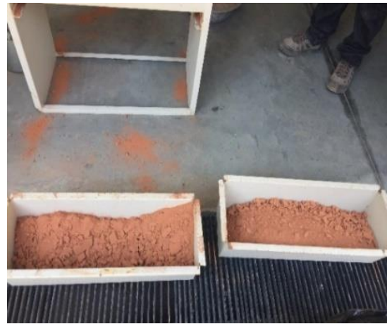
Figura 33. Separación en el cuarteador de las muestras en el laboratorio. Fuente: el autor.
