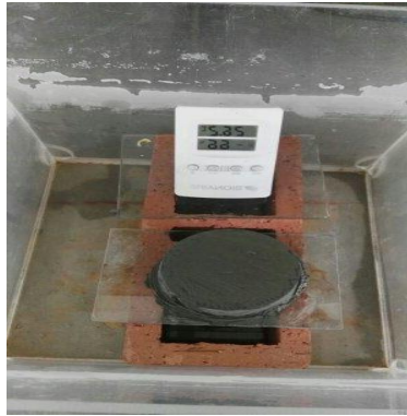
Figura 31. Tiempo de fraguado y control de temperatura. Fuente: el autor.
