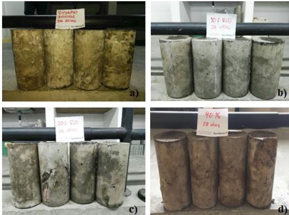
Figura 57. Cilindros ensayados a 28 días: a) diseño base; b) diseño con 10% ARCe; c) diseño con 20% ARCe; y d) diseño con 40% ARCe. Fuente: el autor.
