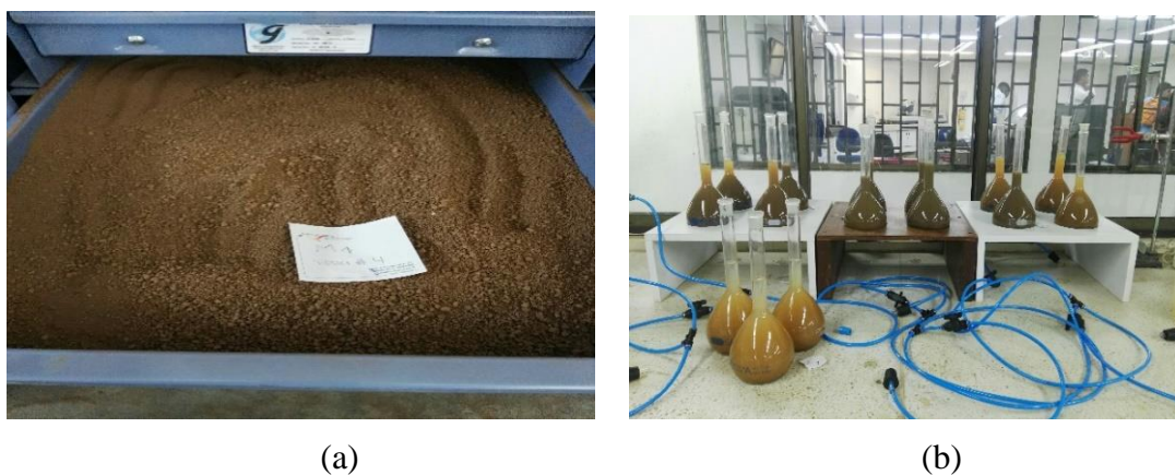
Figura 42. (a) Muestra por el tamiz No. 4; (b) ensayo de gravedad específica. Fuente: el autor.
