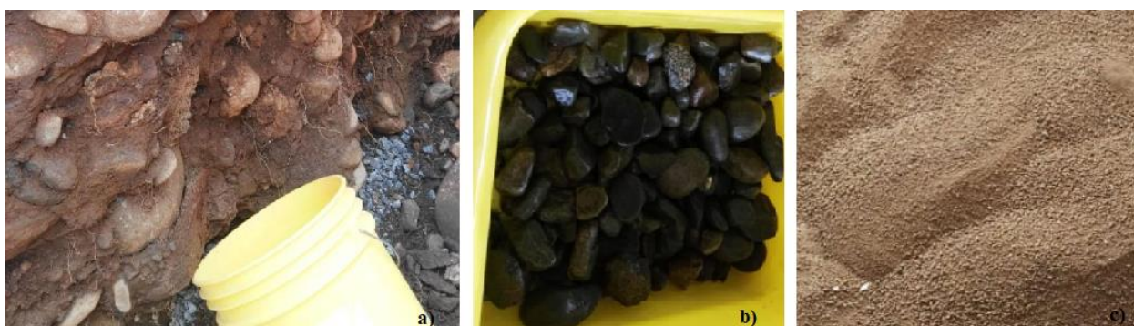
Figura 39. Suelo seleccionado para el retiro: a) en el sitio de obra; b) fracción gruesa retenida en el No. 4 después de tamizado y lavado; y c) matriz fina pasante No. 4 seca al aire.
