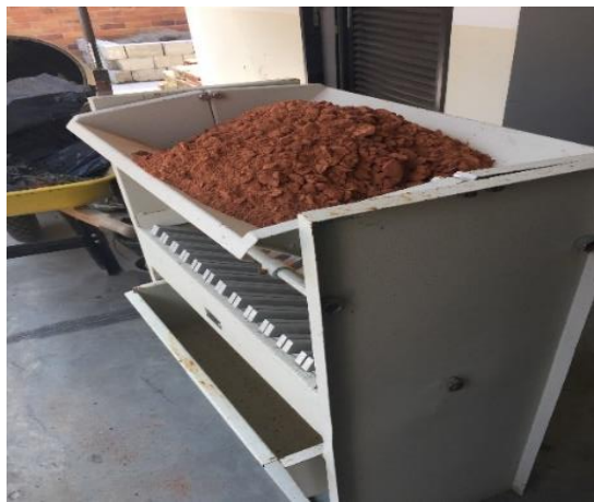
Figura 33. Separación en el cuarteador de las muestras en el laboratorio. Fuente: el autor.
