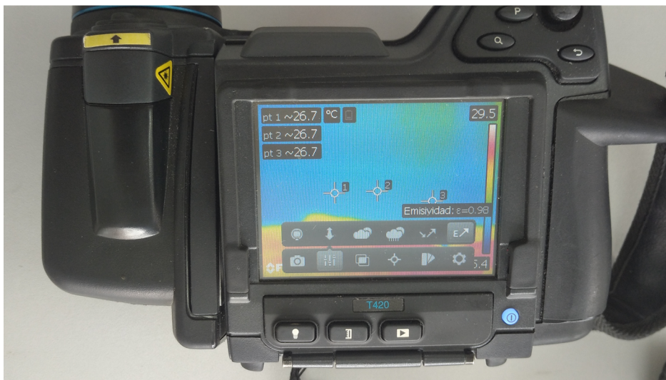
Figura 3.6: Configuración de emisividad de la cámara infrarroja
