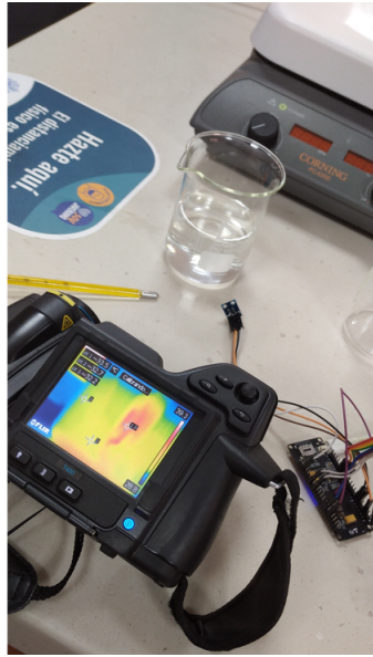
Figura 3.7: Toma de muestras con la cámara infrarroja y el sensor
