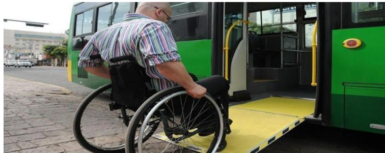
[Fotografía 4]. Rampa de acceso a bus para PCD.
