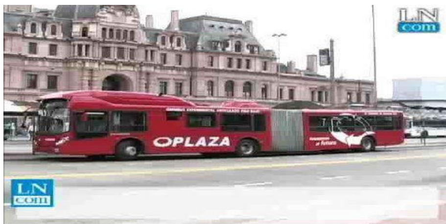
[Fotografía 6]. Ómnibus articulado con fuelle, 18.5 metros de largo, capacidad para 180 pasajeros
