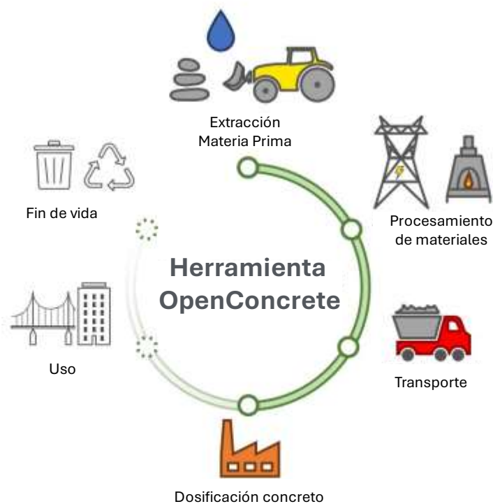
Figura 4. Alcance del análisis de ciclo de vida usando la Herramienta Openconcrete. Adaptado de Kim et al. (2022). Acceso libre bajo licencia CC BY 4.0.
