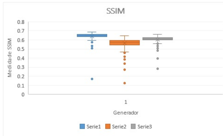
Figura 8.8: Comparación del SSIM en gráfico de cajas para las tres arquitecturas de generadores. Serie 1= Unet++, Serie = Unet, Serie 3=ResNet 9
