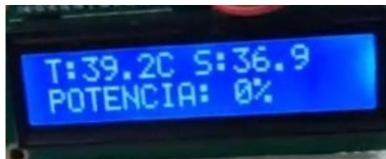
Ilustración 21. Validación experimental de la respuesta del sistema ante una temperatura superior al setpoint.
