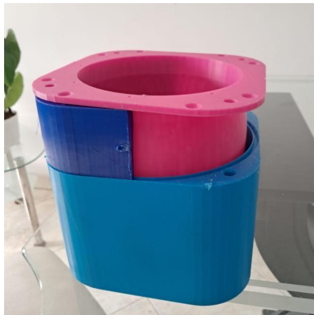
Ilustración 23. Molde fabricado para la conformación del esferoide prolato
