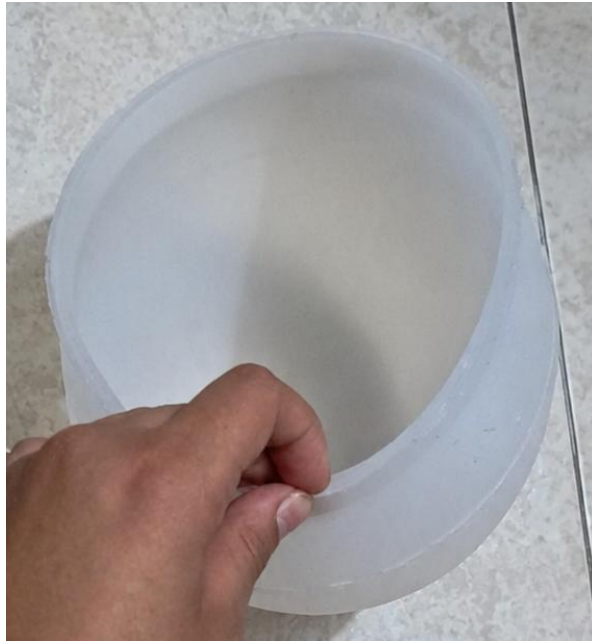
Ilustración 24. Esferoide prolato en silicona escalado al 50%
