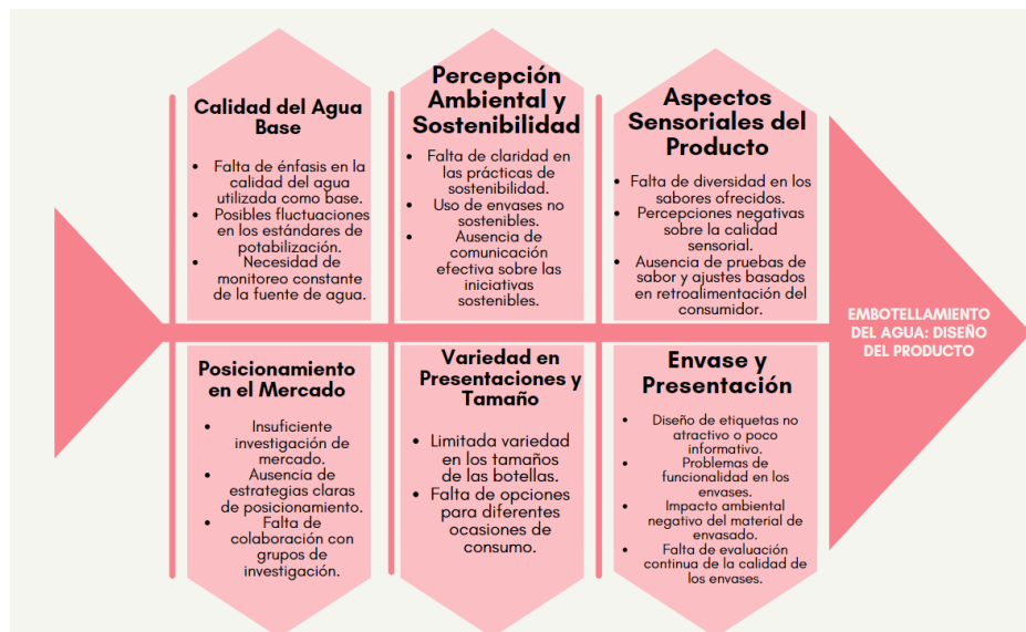
Fig 3. Diagrama de Ishikawa para el diseño del producto de agua embotellada Javeriana Cali
