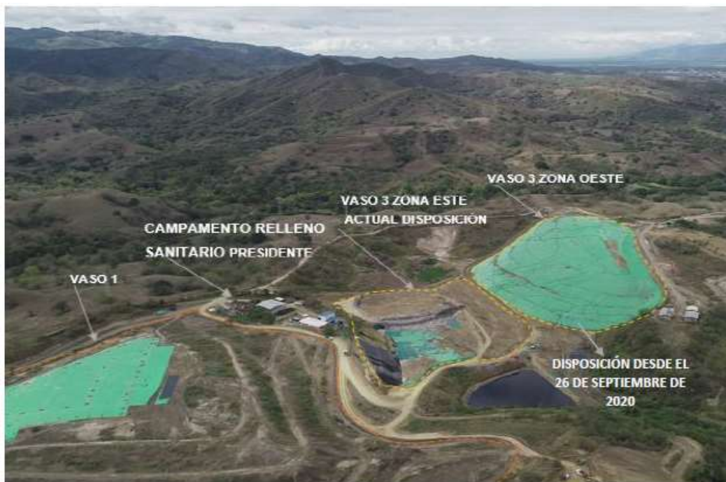
Figura 20. Configuración general del relleno sanitario de Presidente (C&C Ingeología y Geotécnia S.A.S, 2020).
