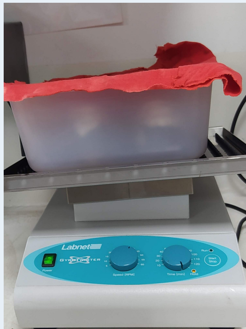
Figura 32. Frascos boca ancha o Erlenmeyer en la plancha de agitación o shaker, para crecimiento micelial
