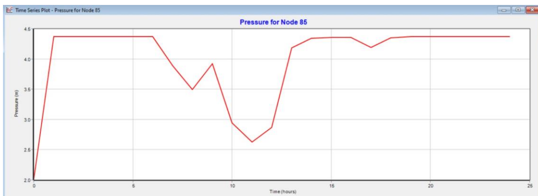
Figura 36 Presión último baño de batería izquierda primer piso
