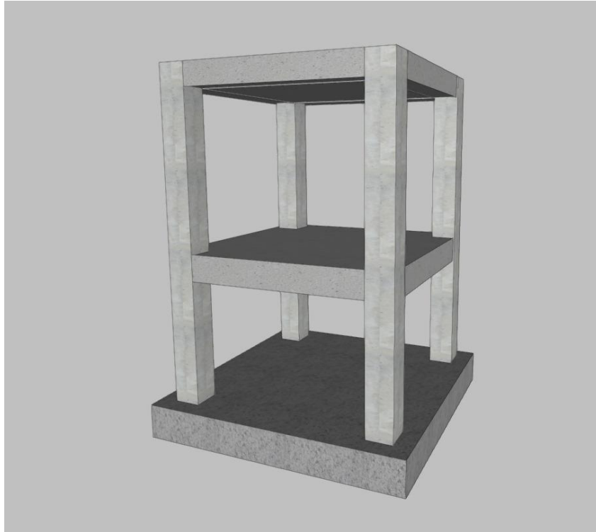
Figura 44 Modelaje de estructura en CYPECAD.
