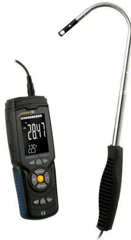
Figura 5. Anemómetro de sonda térmica. Fuente: Tomado de [11].
