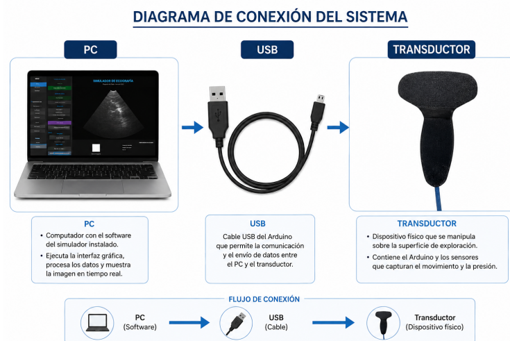
Figura 2.1 Diagrama de conexión del sistema: PC → USB → Transductor
