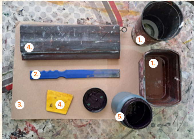
1. Baldes con agua, 2. Mezclador, 3. Papel, 4. Rasqueta, 5. Tinta.
