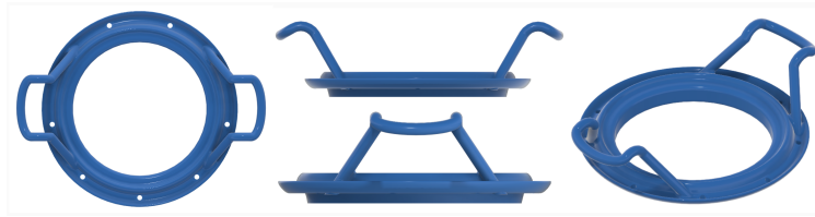
Figura 7.24: Modelo de la manija para acoplar al caucho de silicona
