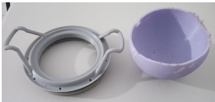
Figura 7.27: Manija impresa en 3D y modelo del esferoide prolato en caucho de silicona
