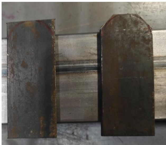
Figura 3.24. Cortes realizados sobre las placas metálicas.
