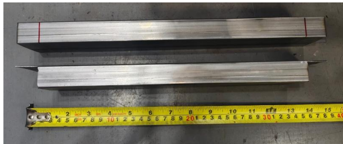
Figura 3.15a. Medición y corte del lado extremo del chasis.
