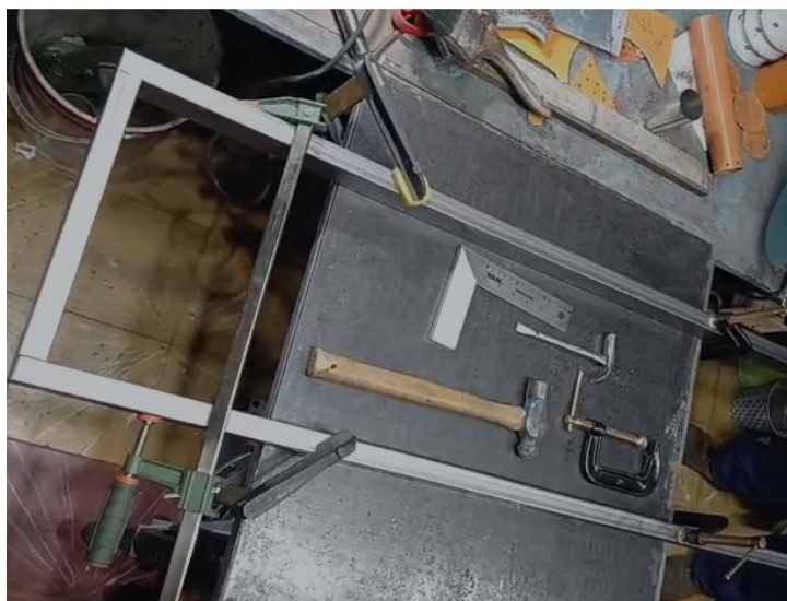
Figura 3.15b. Unión del montaje asegurado con presas.
