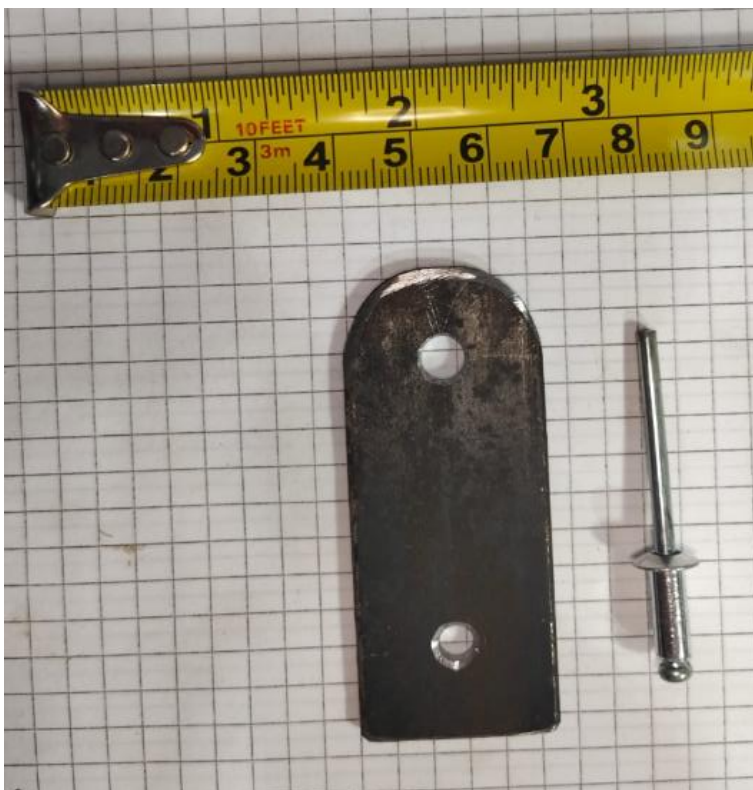
Figura 3.29. Segundo orificio correspondiente al proceso de remachado.
