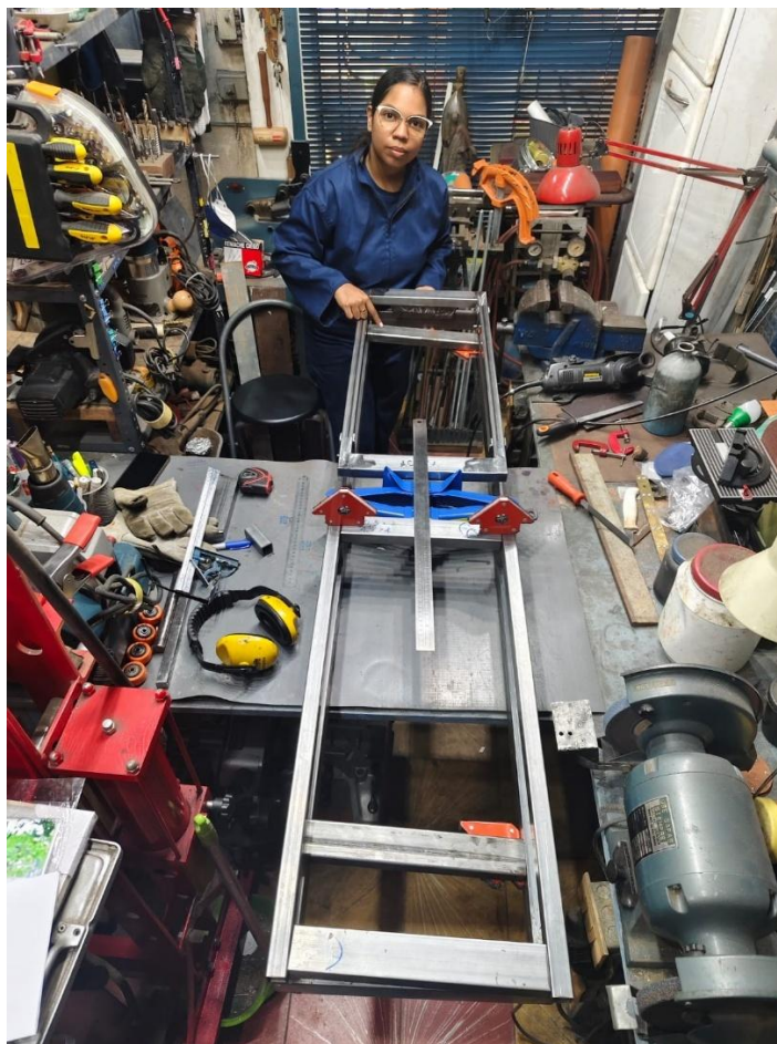
Figura 3.21. Estructura base, carro fijo y carro móvil terminada, agregando mayor resistencia al peso del futuro paciente.
