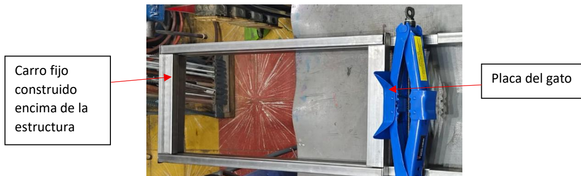
Figura 3.19. Construcción del carro fijo.
