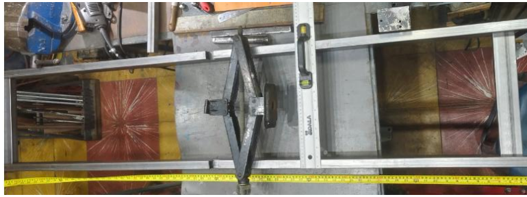
Figura 3.18. Estructura cortada y soldada. Prueba con el gato tijeras.
