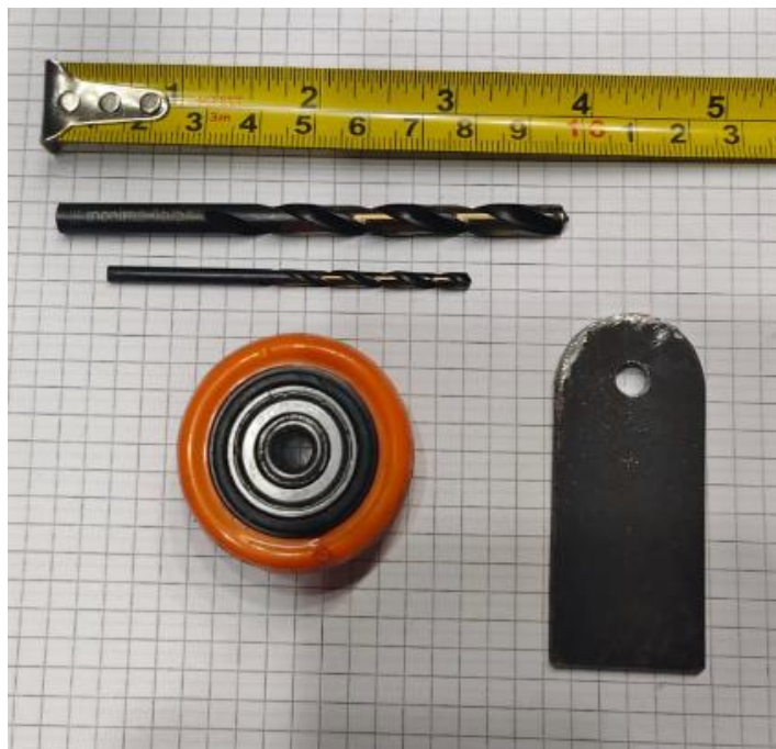
Figura 3.26. Placa con el orificio correspondiente a la rueda usando marca Incolma broca 15/64" y Broca 1/8".
