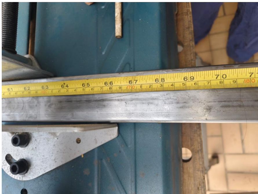
Figura 3.13. Primer corte para la fabricar la estructura base. Lados laterales.
