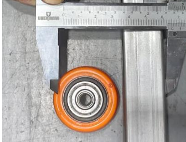
Figura 3.22. Medición de la rueda para la fabricación de los soportes.
