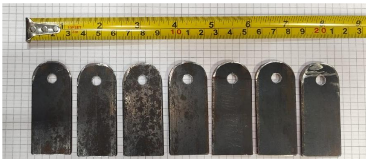
Figura 3.28. Placas bordeadas con orificio perteneciente a la rueda.
