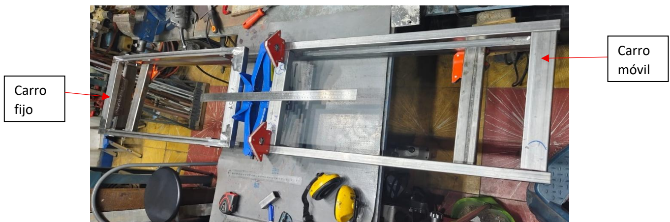
Figura 3.20. Construcción del esqueleto del carro móvil.
