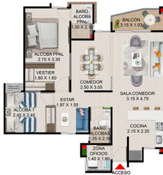
Figura 10 Planta de inmueble tipo – Altea (Constructora Bolívar, 2024).
