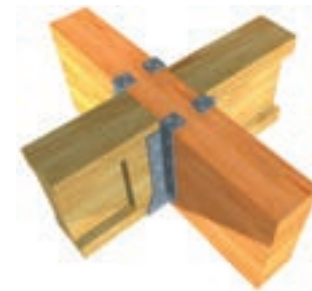
Anclaje metálico entre vigas
