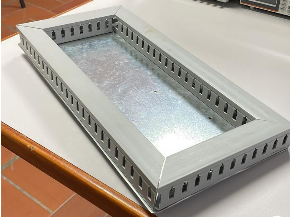
Figura 6.12: Canaleta del tablero eléctrico.
