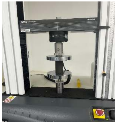
Figura 27. Ensayo de compresión no confinada.
