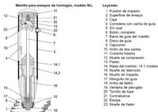
Figura 16. Partes de un esclerómetro
