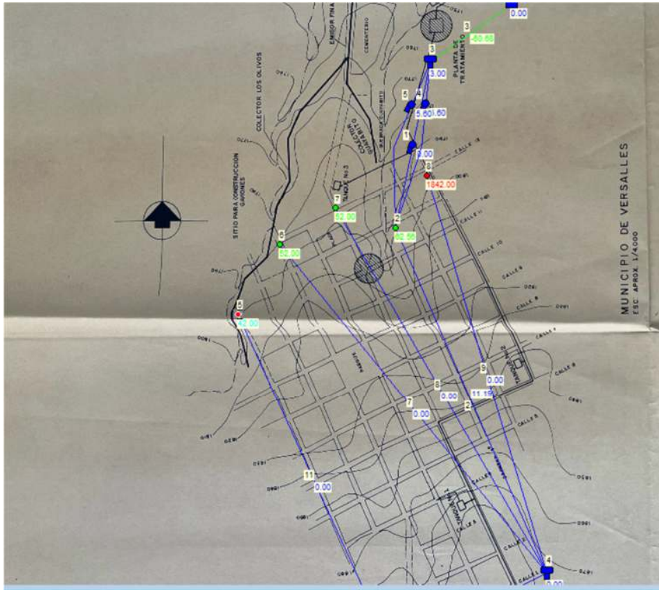
Figura 33 Diseño de sistema de distribución de agua
