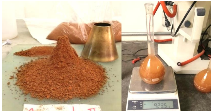
Figura 33. Ensayo de gravedad específica y absorción del agregado fino.
