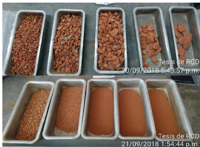
Figura 30. Ensayo granulométrico de agregados reciclados
