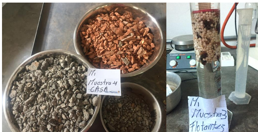
Figura 26. Ensayo de clasificación de agregado reciclado de concreto
