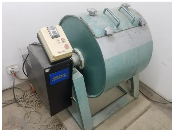
Figura 26. Máquina de los ángeles utilizada para el desgaste en agregados gruesos. Fuente: Propia.
