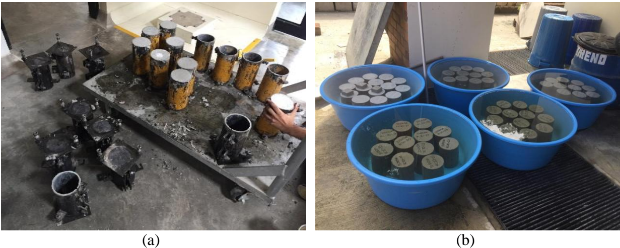
Figura 40. (a) Elaboración de los cilindros de prueba. (b) Curado de los especímenes de ensayo para las mezclas de concreto. Fuente: Propia.
