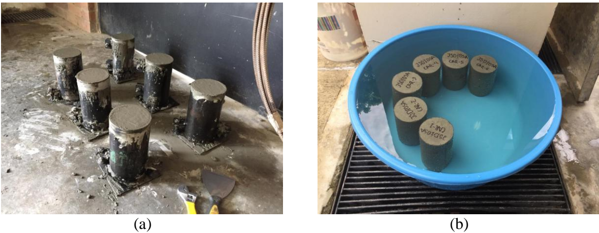
Figura 51. (a) Elaboración de los cilindros de prueba. (b) Curado de los especímenes de ensayo para el concreto de control por asentamiento. Fuente: Propia.
