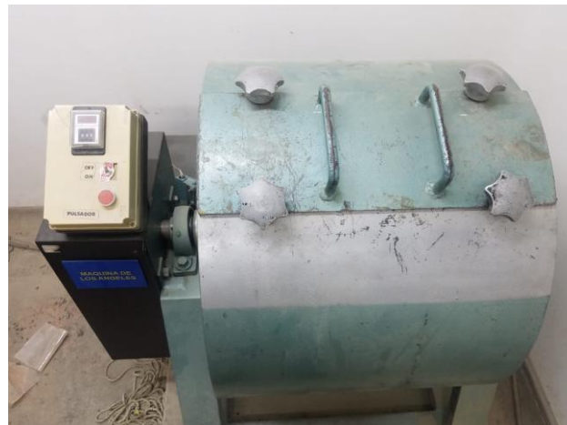
Figura 34. Máquina de los ángeles utilizada para el desgaste en ARC. Fuente: Propia.
