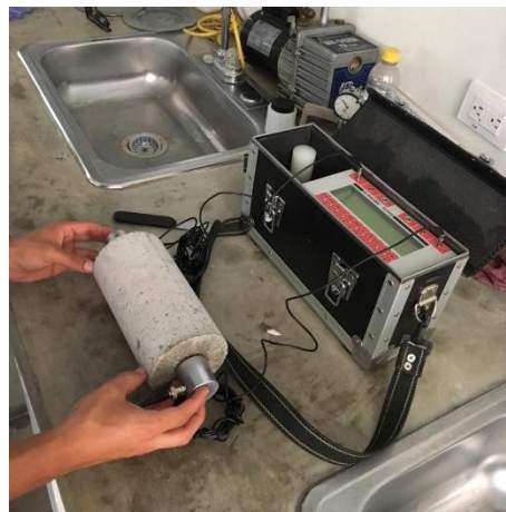
Figura 45. Ensayo velocidad de pulso ultrasónico. Fuente: Propia.
