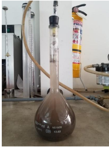
Figura 22. Ensayo gravedad específica y absorción en arena fina, matraz de ensayo. Fuente: Propia.
