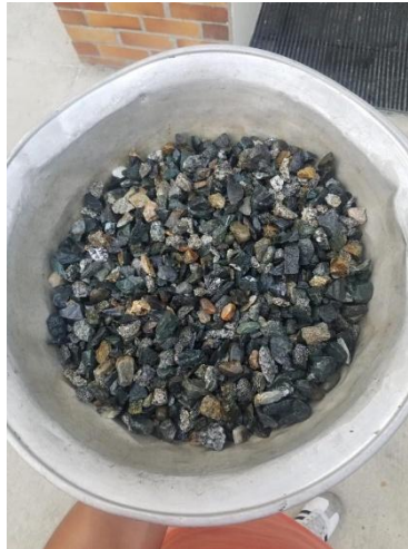
Figura 28. Agregado grueso sumergido para ensayo de densidad específica y absorción. Fuente: Propia.
