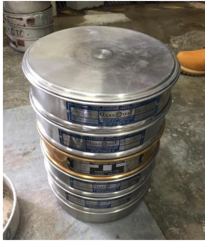
Figura 30. Tamices utilizados para ensayo de granulometría en ARC. Fuente: Propia.
