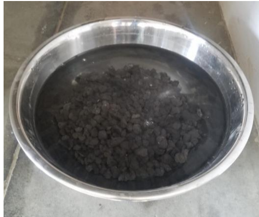
Figura 36. ARC sumergido para ensayo de peso específico y absorción. Fuente: Propia.
