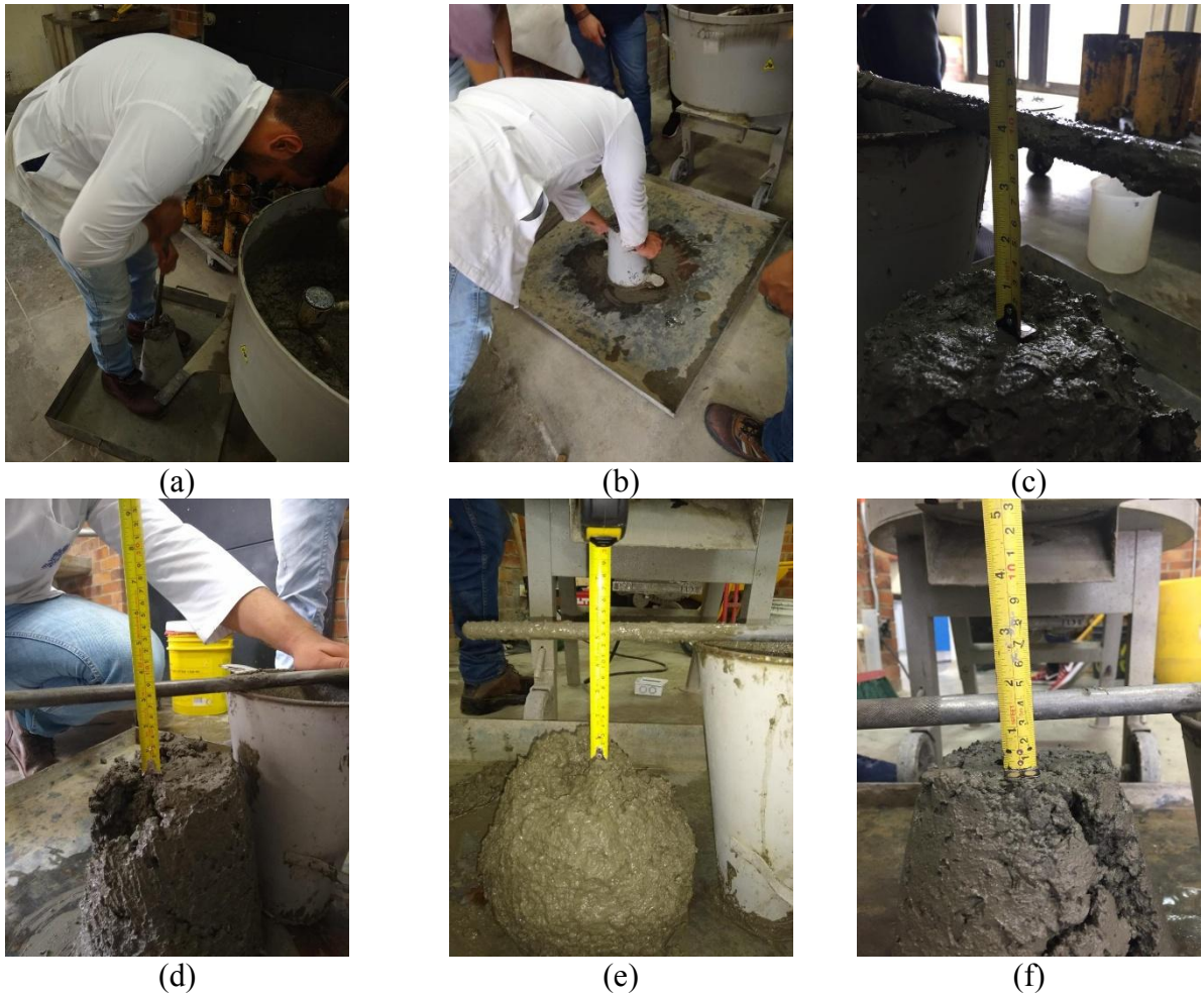
Figura 41. (a) y (b) Procedimiento empleado, utilizando el cono de Abrams. (c) Asentamiento CB. (d) Asentamiento RC10. (e) Asentamiento RC20. (f) Asentamiento RC40. Fuente: Propia.
