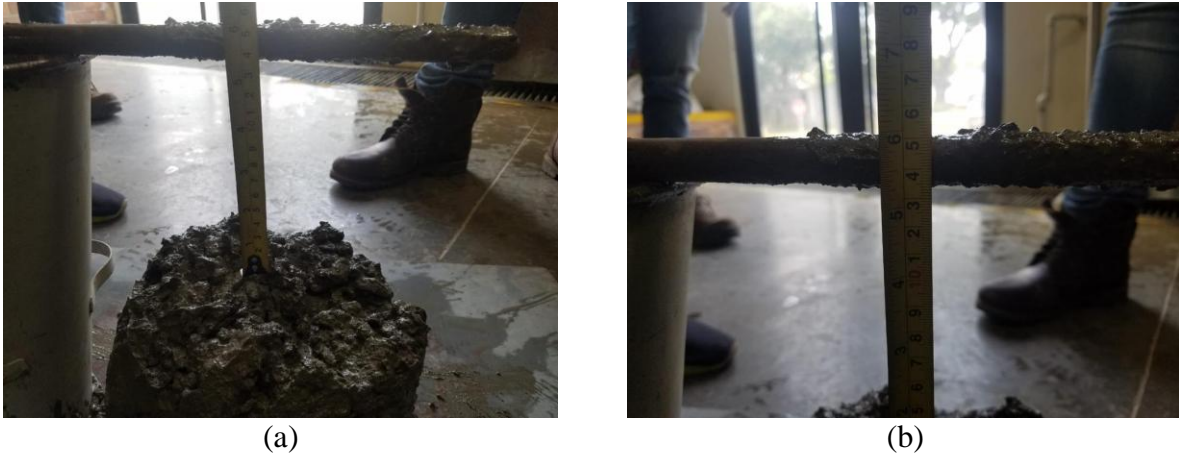
Figura 50. (a) y (b) Asentamiento de la mezcla de concreto con aditivo superplastificante. Fuente: Propia.
