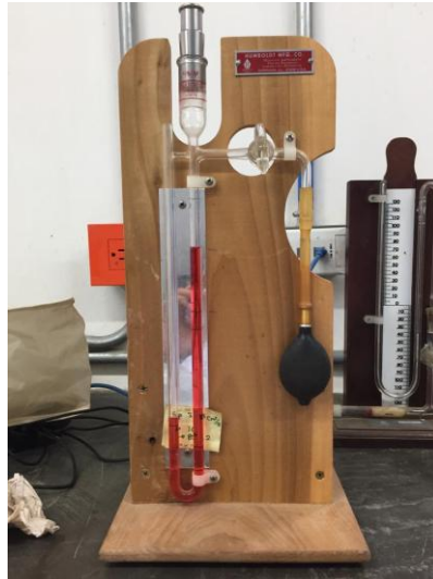
Figura 13. Aparato de Blaine, Ensayo de Finura cemento. Fuente: Propia
