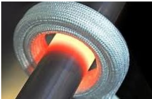
Figura XI. Calentamiento por inducción de un eje [15]
