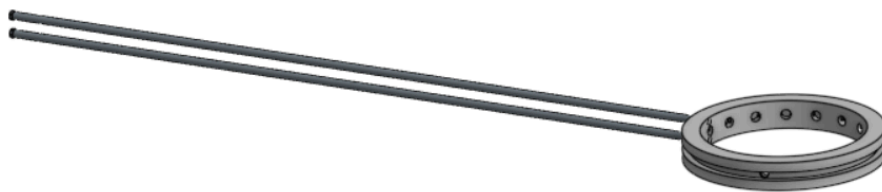
Figura LXXXII. Vista del ensamblaje entre los dos ejes de soporte con el anillo de enfriamiento
