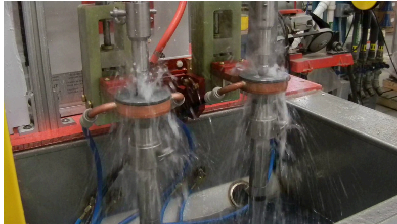
Figura LXXII. Sistema de posicionamiento y movimiento axial de una muestra en un horno de inducción encontrado en la industria [40]
