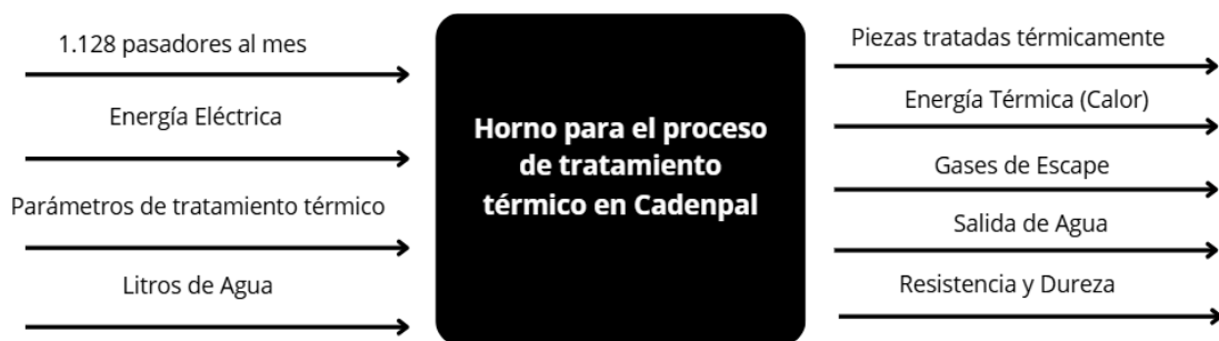
Figura XVI. Caja negra del horno de tratamiento térmico
