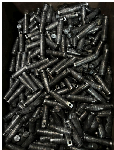
Figura IV. Pasadores fabricados en Cadenpal Tomada de: Mecanizados Industriales Cadenpal E.U
