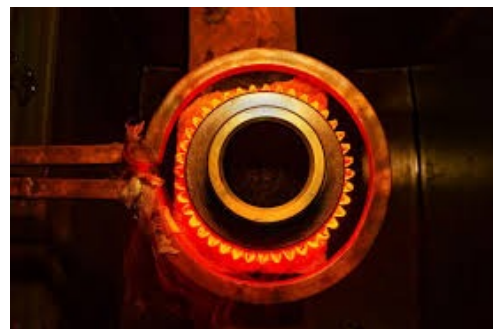
Figura XII. Calentamiento por inducción en una rueda dentada [15]
