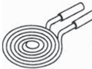
Figura XLV. Diseño de Bobina tipo pancake [32]
