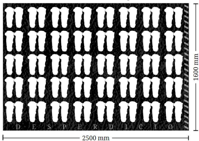
Fig. 28 Desperdicios de espuma en rodilleras
