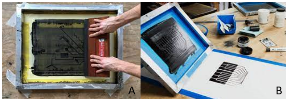
Figura 5.3: A) Proceso de impresión, esparciendo la tinta sobre el molde. B) Sensor final. Modificado de: [4]
