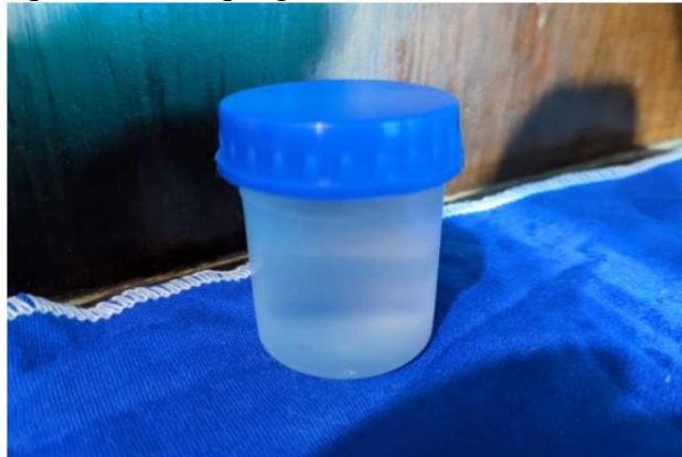
Figura 4.2. Solución buffer de pH con valor de 7.0 para calibración de sensor
