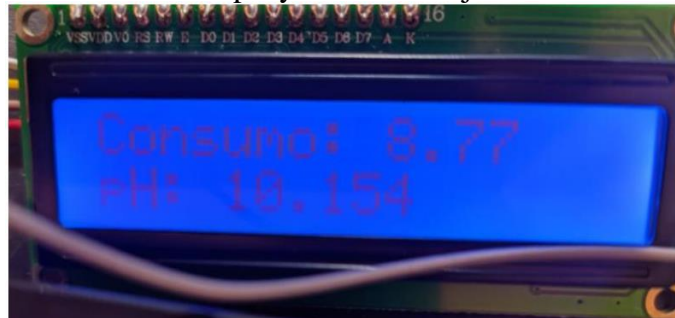
Figura 4.4. Datos de consumo y pH de agua potable en pantalla LCD.
