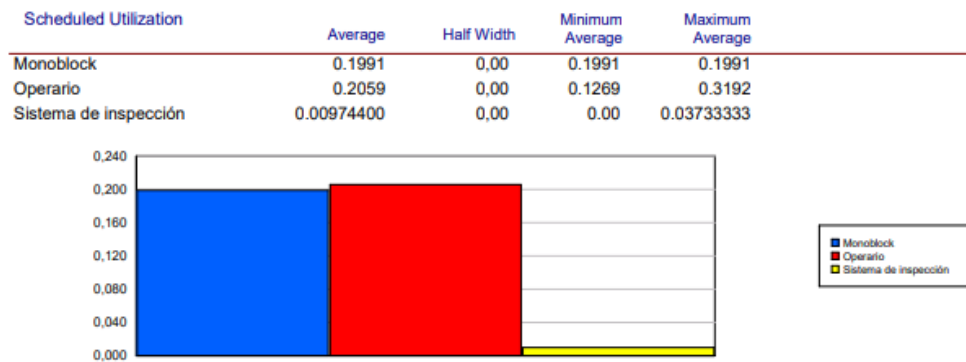
Figura L. Histograma de utilización de las máquinas de la planta – proceso propuesto de embotellado 0,5L.
