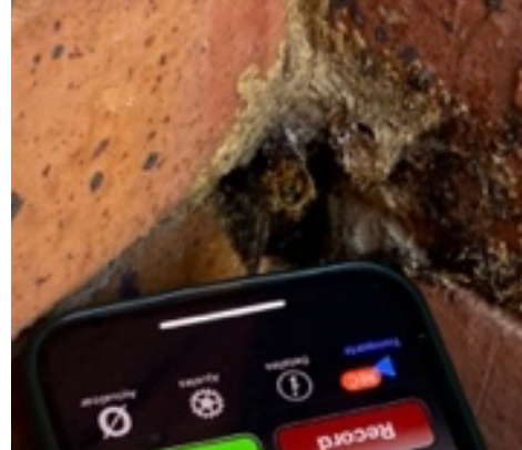
Figura 4. Micrófono del dispositivo celular tomando datos a \approx 2 cm de la colmena
