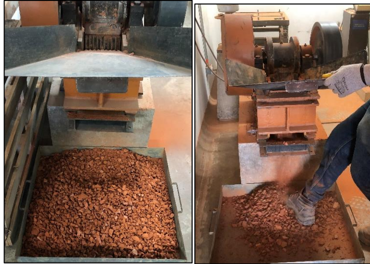
Figura 11. Proceso de trituración mediante trituradora de mandíbulas laboratorio PUJ Fuente: Propia.
