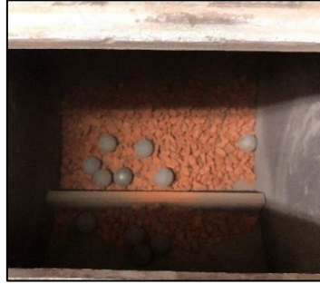
Figura 16. ensayo de resistencia al desgaste mediante la Máquina de los Ángeles. Fuente: Propia.
