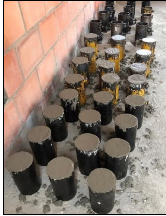
Figura 20. Especímenes de concreto en estado fresco. Fuente: Propia.
