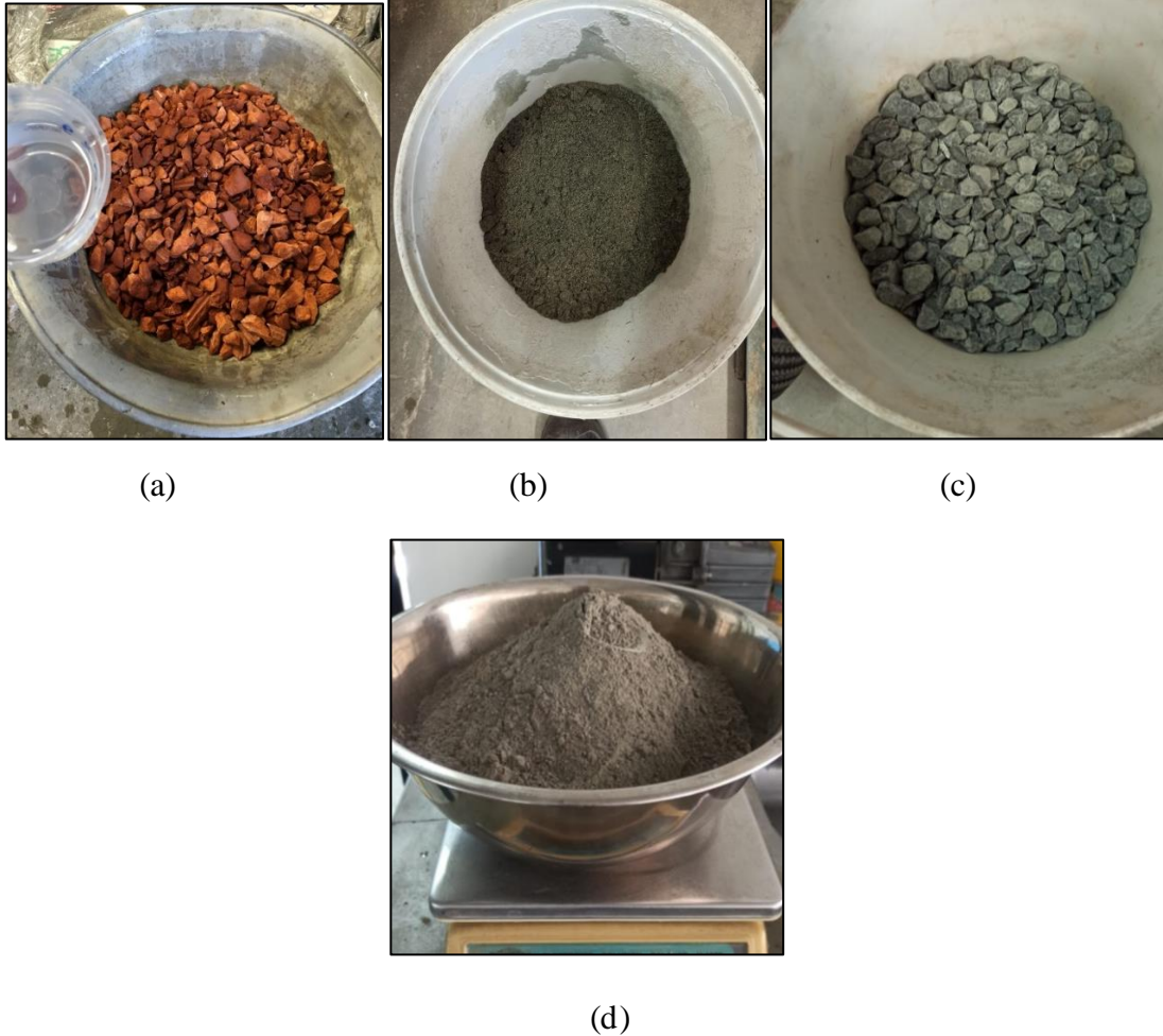
Figura 25. Materiales utilizados en fundición. (a) saturación previa del ARC, (b) agregado fino, (c) agregado natural grueso y (d) cemento de uso general. Fuente: Propia.
