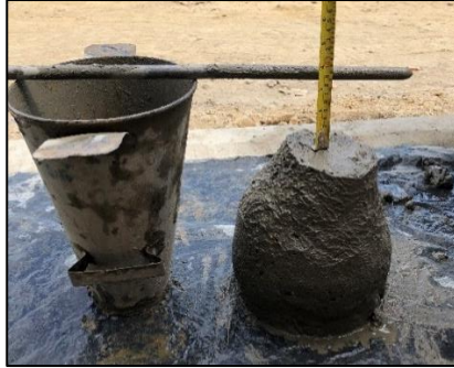
Figura 22. Ensayo de asentamiento bajo norma NTC 396. Fuente: Propia.
