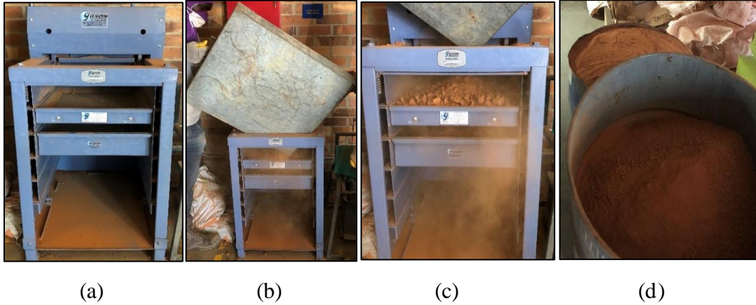
Figura 12. separación del agregado reciclado mediante tamizadora mecánica. (a) Tamizadora mecánica, (b) se ingresó el material no tamizado, (c) proceso de separación mediante malla # 4 y (d) material fino tamizado. Fuente: Propia.
