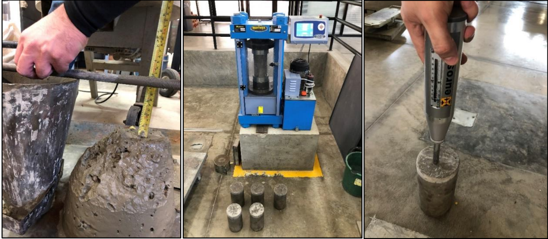
Figura 26. (a) ensayo de asentamiento, (b) ensayo de resistencia a compresión, y (c) ensayo de esclerometría. Fuente: Propia.
