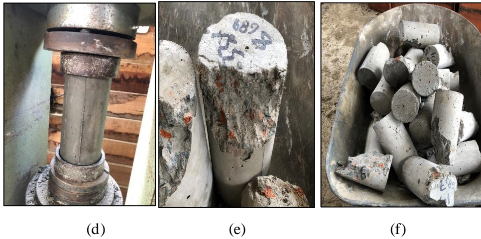
Figura 23. Ensayo de compresión. (a) registro de masa, (b) registro de diámetros, (c) y (d) ensayo en ejecución, (e) espécimen ensayado y (f) recolección de especímenes ensayados. Fuente: Propia
