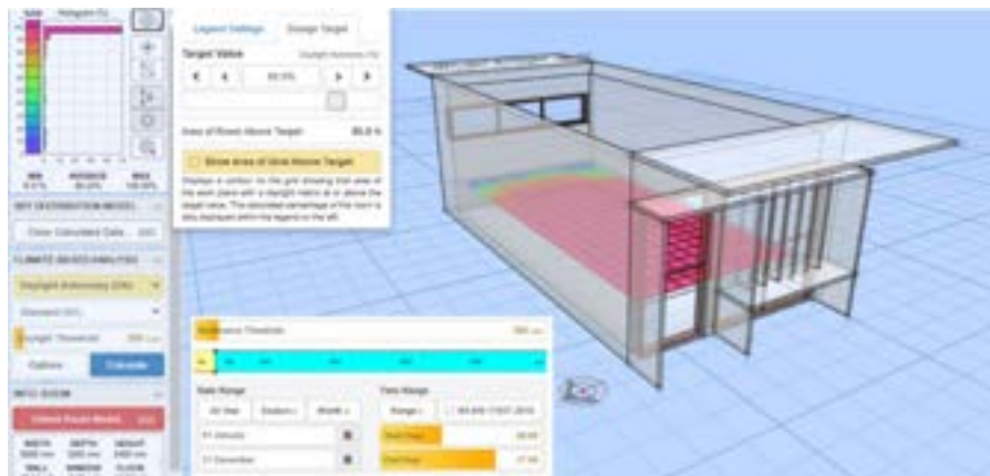
Figura 64: Simulación iluminación módulo de oficina Andrew Marsh.
