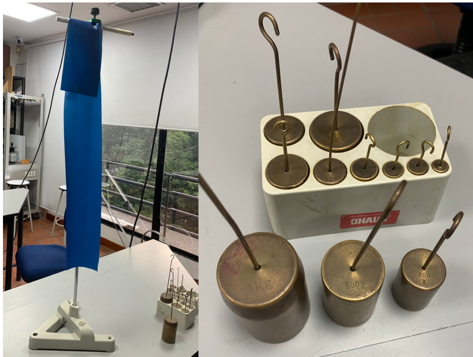
Figura 31. Ensayo de laboratorio ley de Hooke
