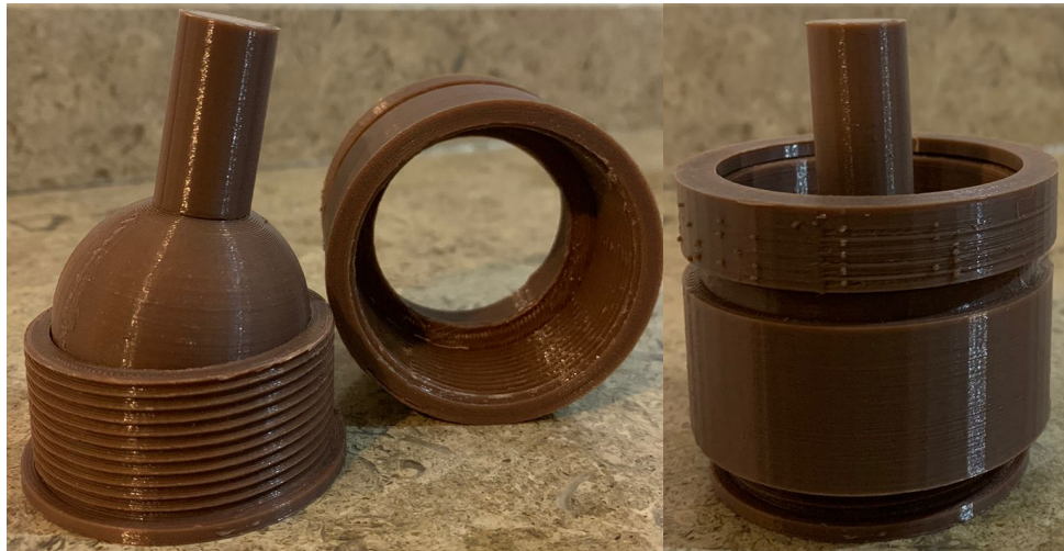
Figura 25. Prototipo 1. Junta con sistema de fricción
