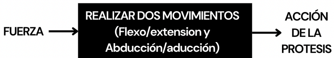
Figura 20. Diagrama de caja negra para muñeca protésica.
