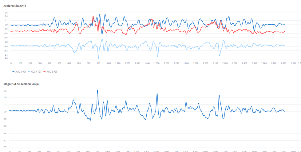
Figura 79- Señal IMU segmento anterior del muslo derecho - arena: Elaboración propia
