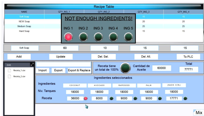
(a) Alarma de error al detectar cantidad insuficiente de ingredientes para dicha receta
