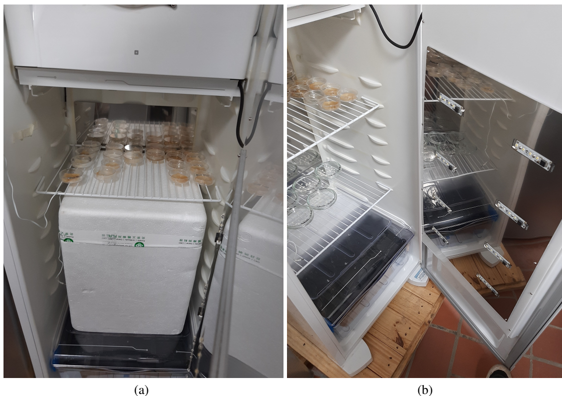
Figura 7.3: Segunda opción de cámara de crecimiento - (a) Caja de icopor número 2, (b) Cámara de crecimiento número 2
