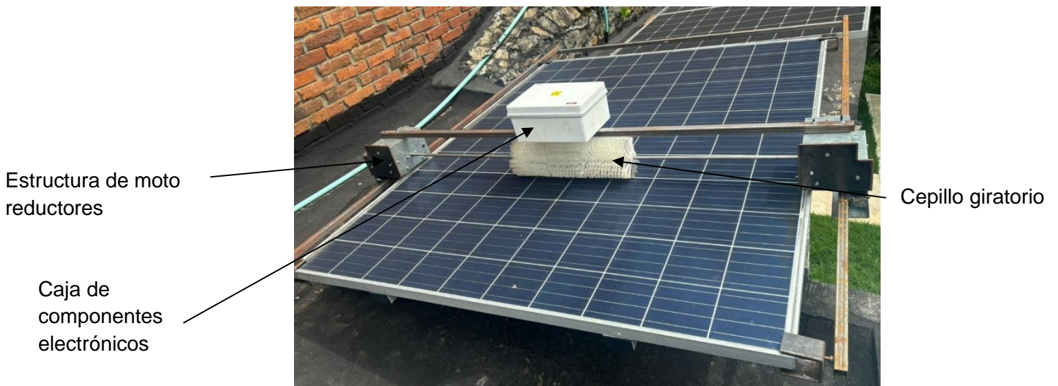
Figura 36. Prototipo final del robot sobre el panel de referencia
