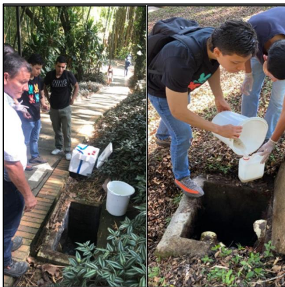
Ilustración 16. Toma de muestras de agua residual.
