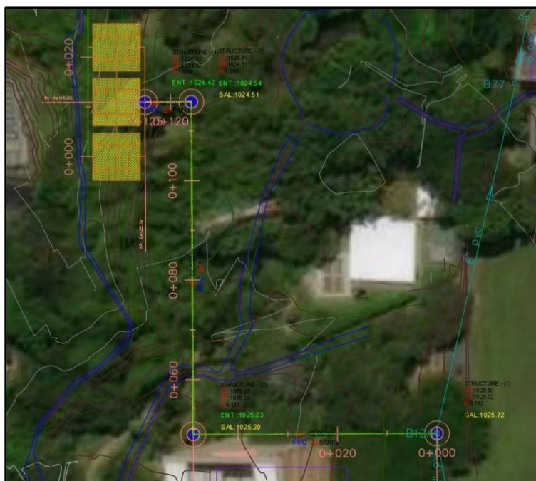
Ilustración 36. Trazado de tubería en Civil 3D
