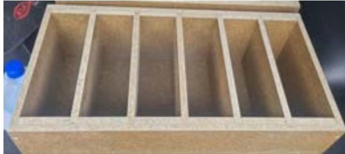
Figura 50: Formaletas en panel MDF laminado con capacidad para 6 bloques cada una.
