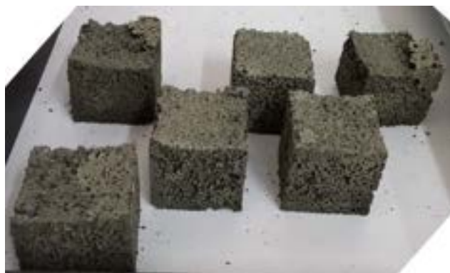
Figura 35: Cubos deformados de fundición con espuma preformada sin diluir
