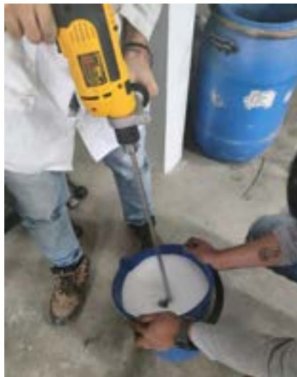
Figura 27: Espuma generada con taladro y aditamento
