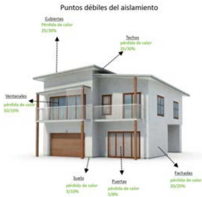
Figura 3: Aislamiento térmico de una vivienda con porcentajes de incidencia de calor en el exterior (Rengifo & Yupangui, 2013a).
