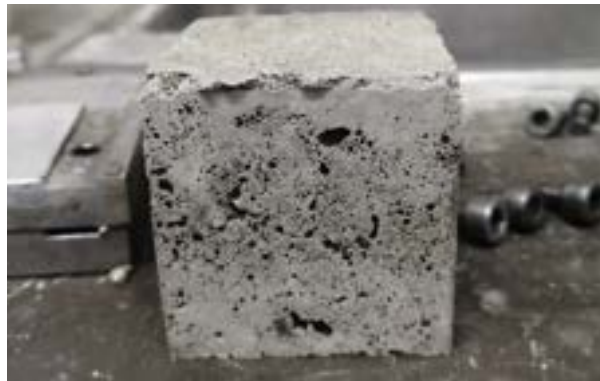
Figura 20: Prisma de primera fundición de concreto celular
