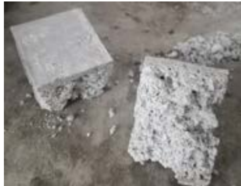
Figura 36: Cubos frágiles y desintegrados en fundición con aditivo diluido a 1/40
