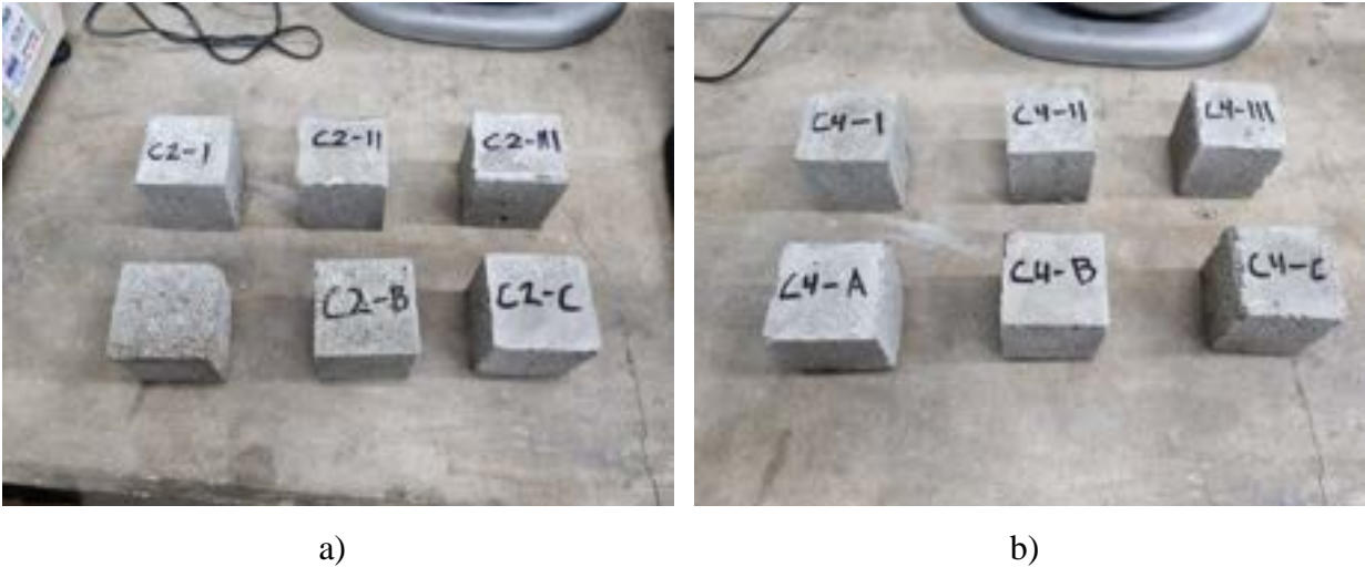
Figura 38: Cubos desencofrados tras 24 horas de fundición de mezcla a)1/20 y b)1/40
