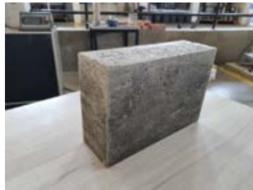
Figura 51: 12 bloques fundidos de 10x20x30 cm de concreto celular
