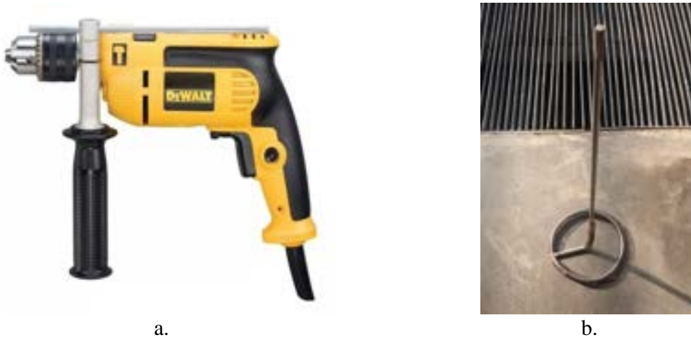
Figura 22: Elementos para agitador mecánico: a) Taladro percutor de velocidad variable y b) varilla lisa con terminación circular rodeada de resortes
