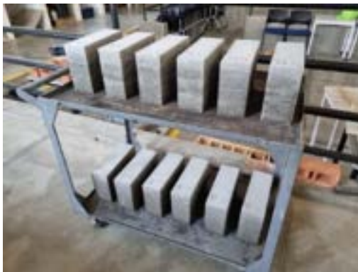
Figura 51: 12 bloques fundidos de 10x20x30 cm de concreto celular
