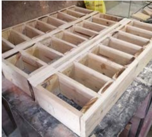
Figura 46: Juego de tres formaletas fabricadas en madera de pino con 8 secciones de 10x12,5x22cm.
