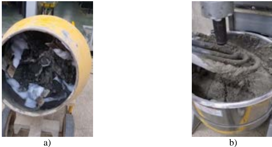
Figura 43: a) Espuma adherida en aspas de mezcladora convencional. b) Mezcla homogénea de concreto celular en mezcladora pastelera grande
