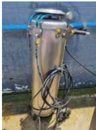
Figura 23: Tanque generador de espuma
