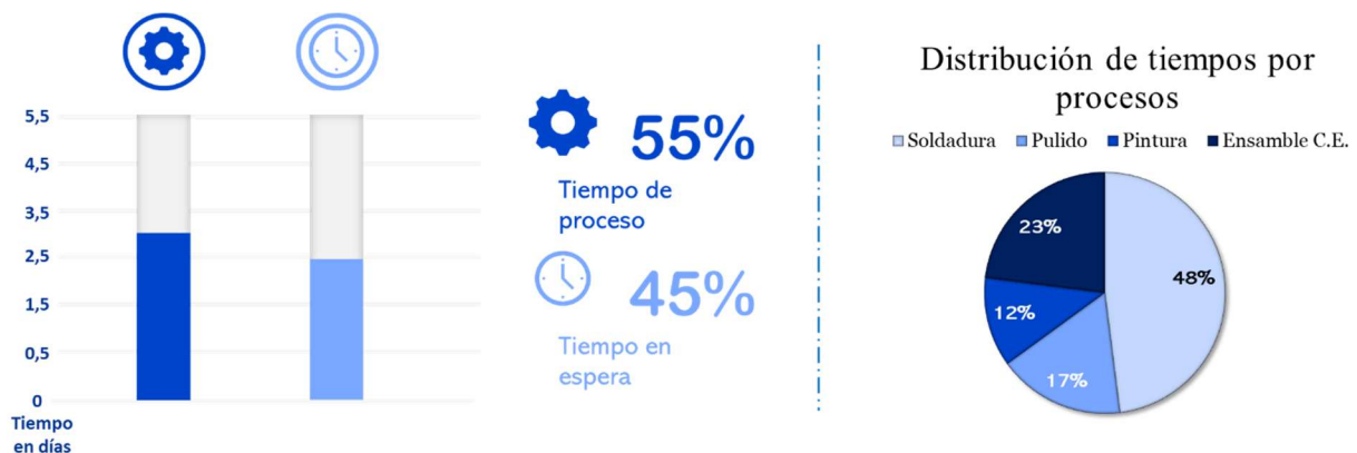
Fig. 10 Eficiencia del tiempo de ciclo de la fabricación de colectores y distribución de tiempos por procesos. Fuente: Elaboración propia
