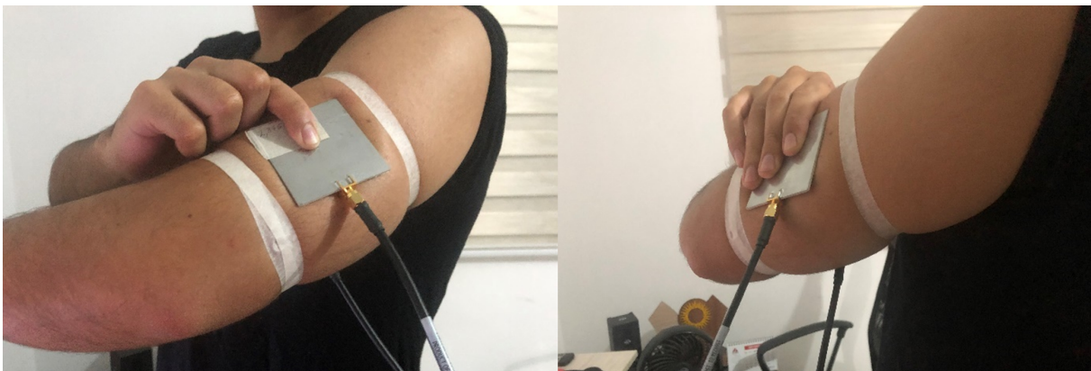
Figura 3.9: Transceptor. Implementación Física
