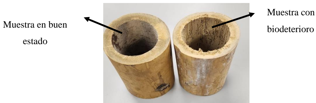
Figura 41 Guadua con y sin biodeterioro
