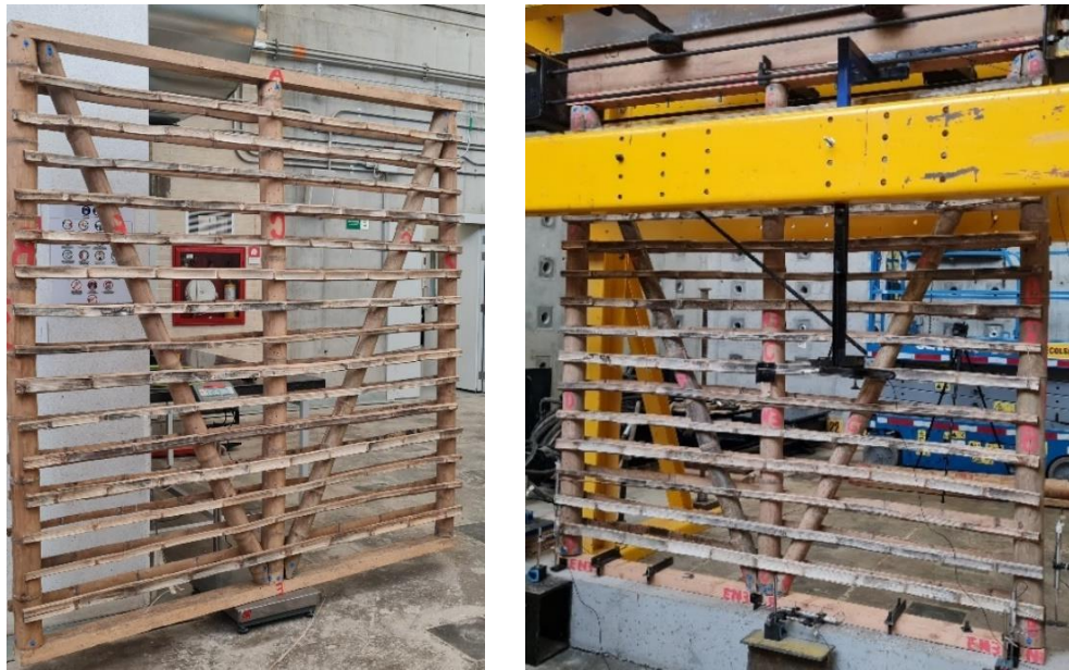
Figura 75 Montaje del prototipo GSH, esqueleto con pies de guadua con latas y hueco
