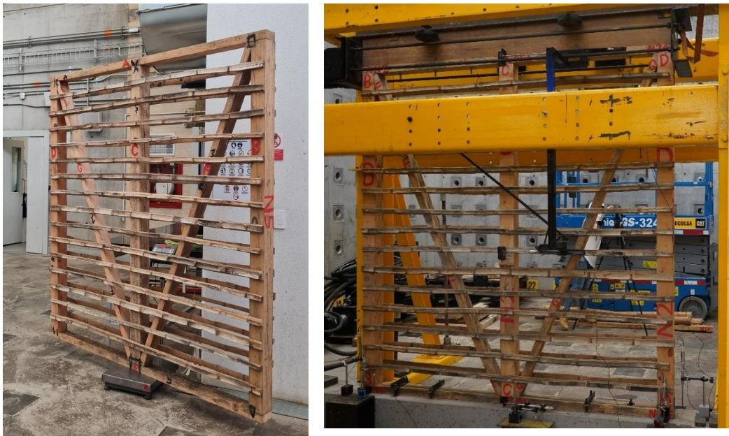
Figura 70 Montaje prototipo TSH, esqueleto con pies de en madera con latas sin relleno.
