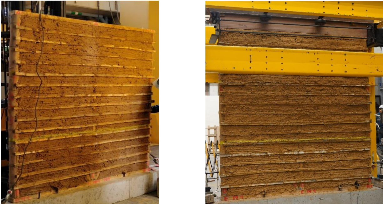
Figura 80 Montaje del espécimen GSHS esqueleto con latas de guadua y relleno de tierra.
