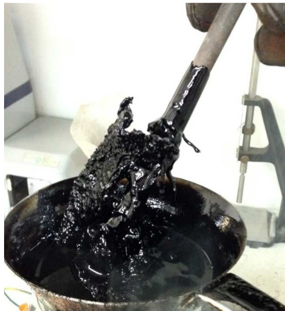
Figura 13. PET aglutinado en el asfalto. Fuente: Autores.
