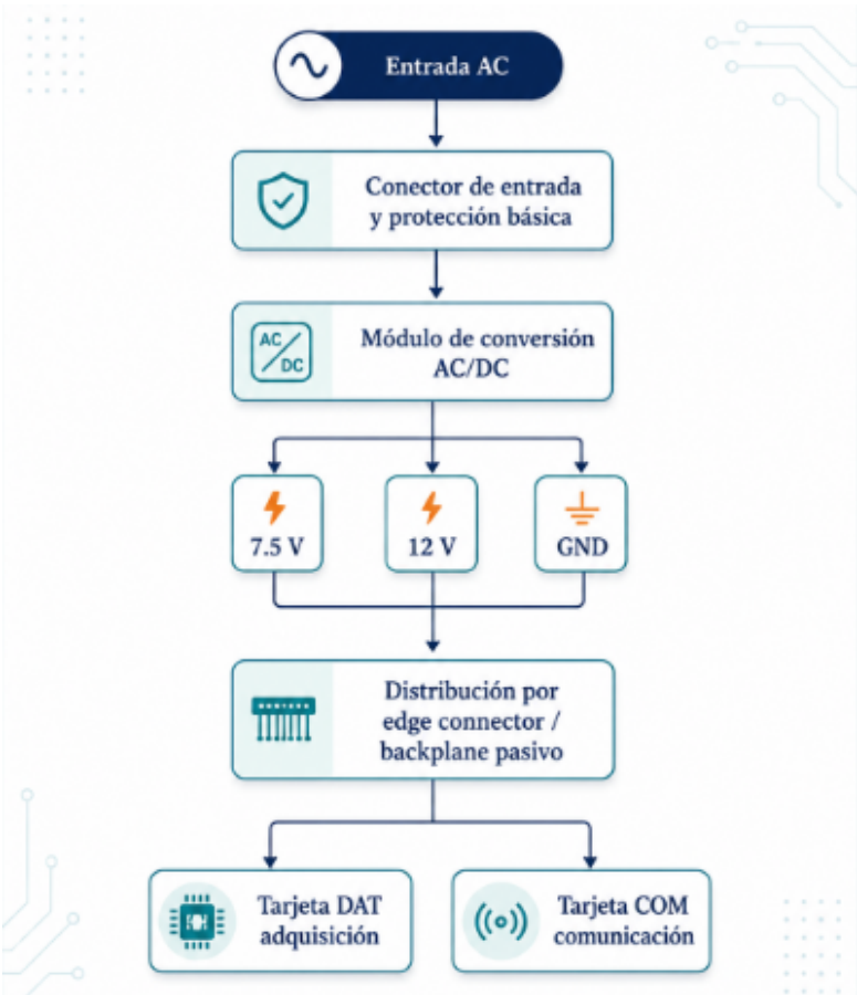
Figura 6.2: Diagrama de bloques de la tarjeta POWER
