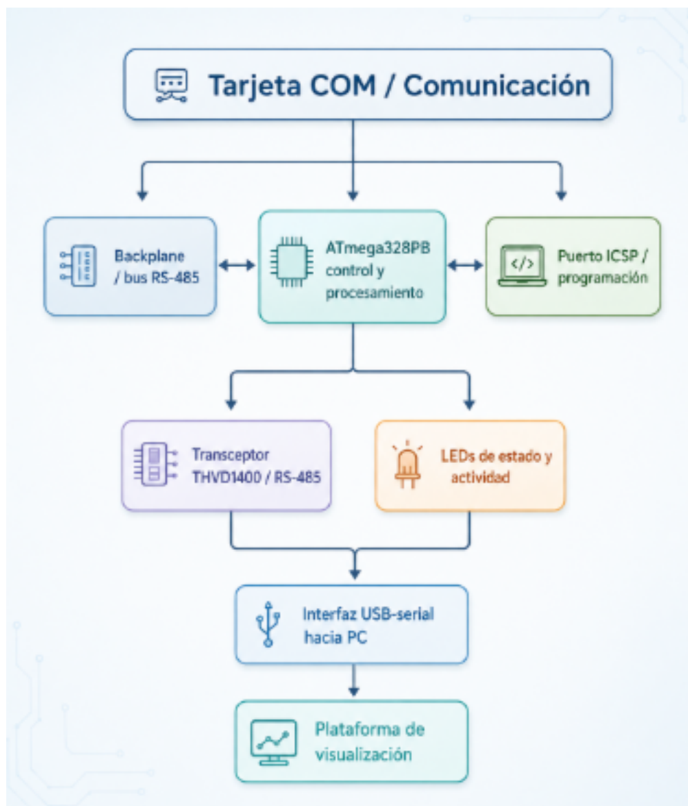
Figura 6.4: Diagrama de bloques de la tarjeta COM
