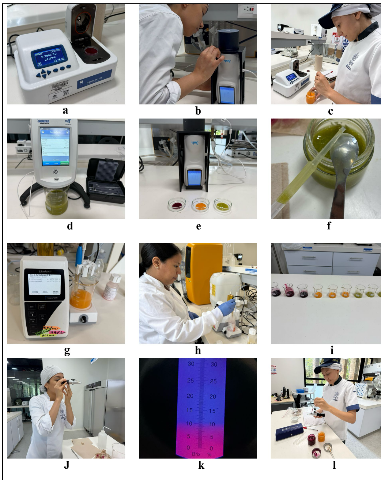
Figura 18. Experimentos fisicoquímicos en el laboratorio. (a) Medición de actividad de agua. (b) Medición de colorimetría a cargo de Maria Jose. (c) Medición de actividad de agua a cargo de Laura. (d) Medición de viscosidad. (e) Las tres salsas en la prueba de colorimetría. (f) Pipeta con salsa de nopal. (g) Medición de pH y acidez titulable. (h) Encargada Jennifer en la medición de pH.
