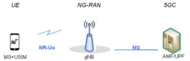
Figura 5. Estructura general de una red móvil 5G, extraído de [36].
