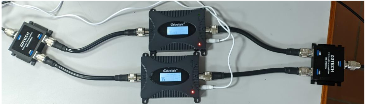
Figura 45. Sistema sin antenas conectado al VNA.
