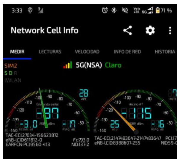
Figura 36. Lectura de 5G NSA en el edificio.
