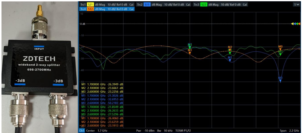
Figura 39. Prueba de aislamiento de puertos.
