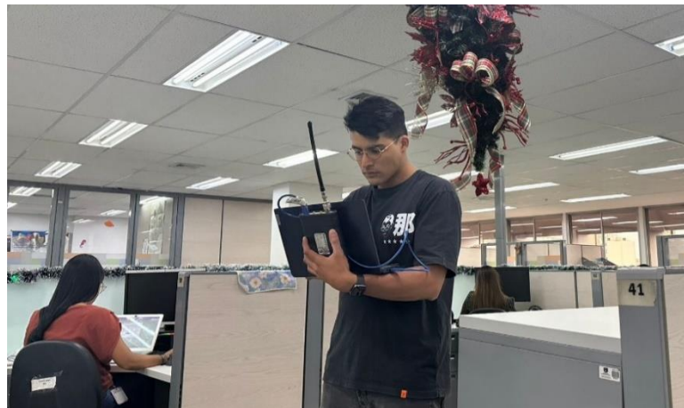
Figura 57. Toma de una muestra con RSA306B.
