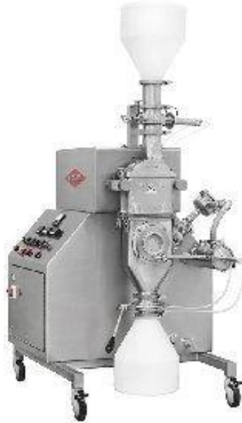
Ilustración 11. Molino de martillo. Fuente: INDUCAMP, 2022
