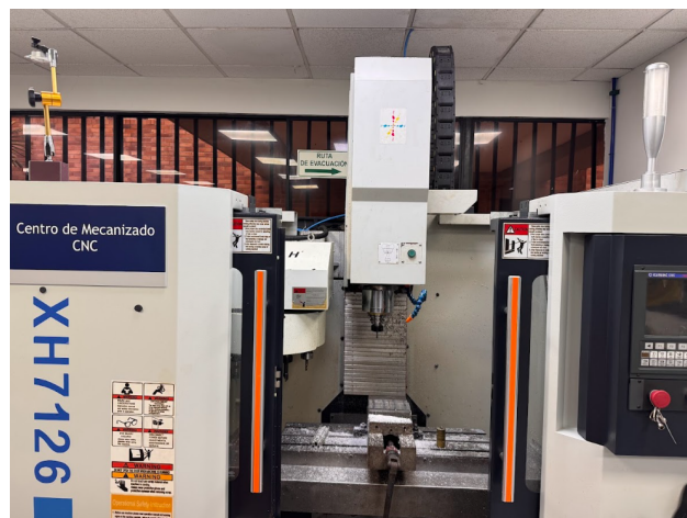
Figura 10.3: CNC utilizado para perforar las estacas.
