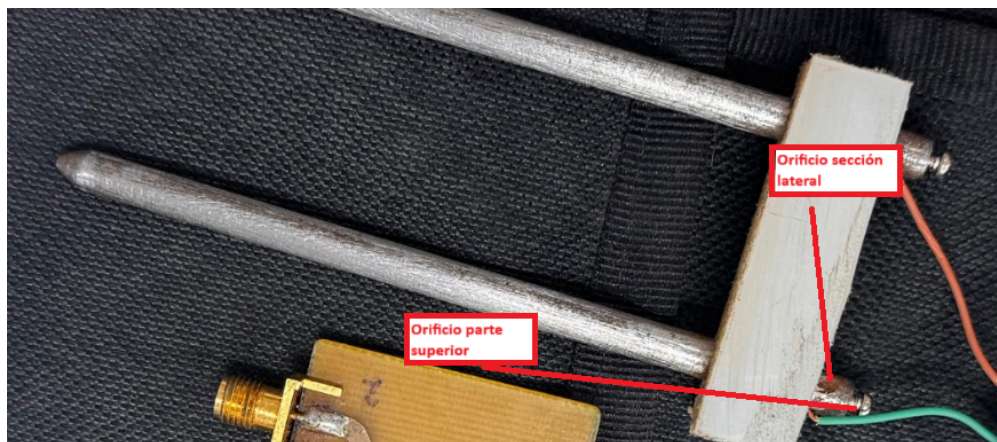
Figura 6.21: Orificios señalados en las estacas del sensor
