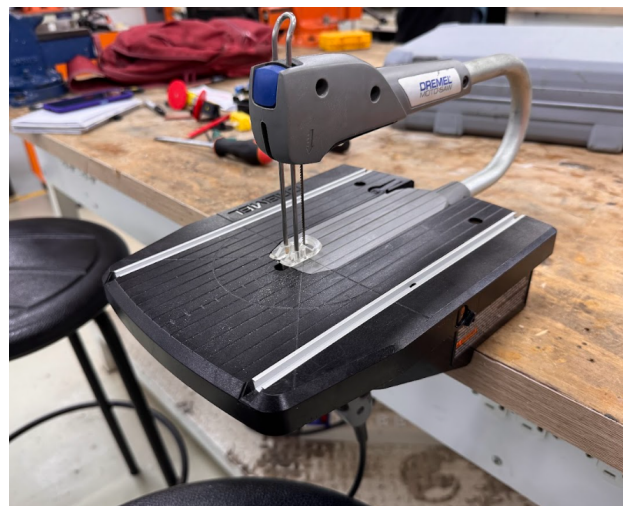
Figura 6.24: Sierra caladora usada para cortar el circuito.
