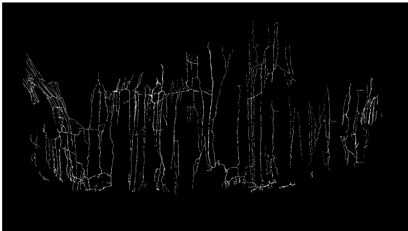
Anexo 7. Mascara manual para deterioro galerías.
